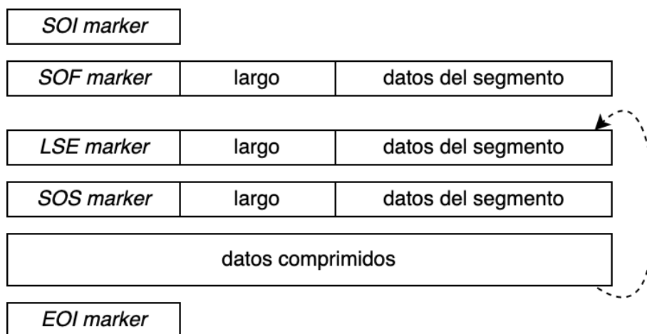
Figura 3.5: Esquema de la estructura de una imagen JPEG-LS a partir de sus marcadores.
