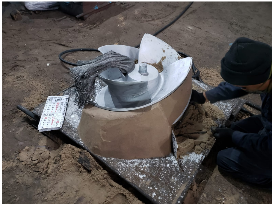
Figura 43: Caja de noyos para fabricar molde de un rotor de una bomba helicoidal.
