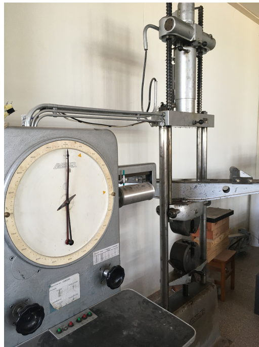
Figura 10: Prensa hidráulica para ensayo de tracción
