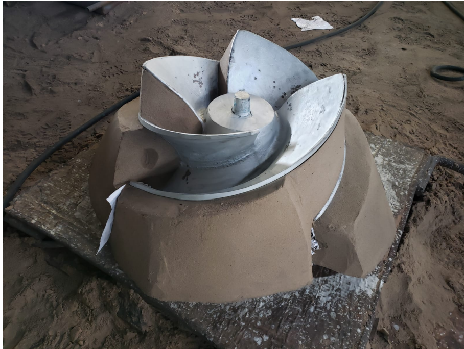
Figura 44: Caja de noyos para fabricar molde de un rotor de una bomba helicoidal.
