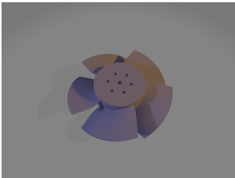
Figura 17: Modelo 3D del rotor para banco de ensayos.
