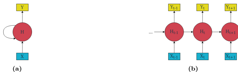
Figura 2.5: Unidad estándar de Red Neuronal Recurrente. En este caso, X corresponde a la entrada, H a la unidad de procesamiento e Y a la salida. Puede verse que existe una conexión consigo misma, que le permitirá incluir información contextual para el siguiente salto de tiempo. En la subfigura b , la unidad desplegada a través del tiempo. Aquí queda más claro como la conexión que existe consigo misma «transporta» información de contexto hacia el siguiente salto de tiempo.
