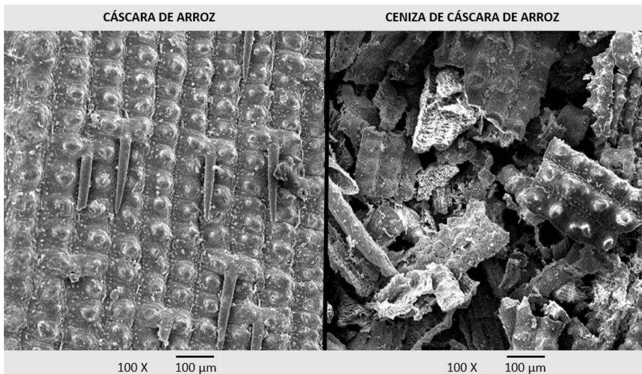
Figura 7. Imágenes SEM de la cáscara de arroz y la ceniza de cáscara de arroz original.
