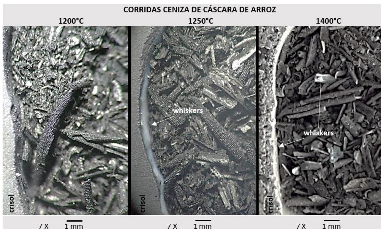
**Figura 15. Micrografías ópticas de los ensayos empleando ceniza de cáscara de arroz original para las temperaturas de meseta de 1200°C, 1250°C y 1400°C.**
