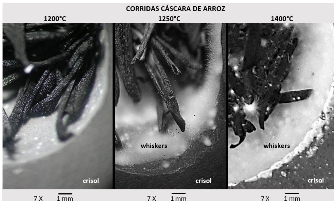
Figura 10. Micrografías ópticas de los ensayos empleando cáscara de arroz para las temperaturas de meseta de 1200°C, 1250°C y 1400°C.
