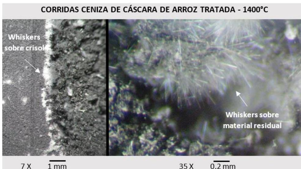
**Figura 26. Micrografía óptica de los resultados del ensayo a 1400°C empleando ceniza de cáscara de arroz tratada. Crisol con material residual (izquierda) y whiskers sobre material residual dentro del crisol (derecha).**
