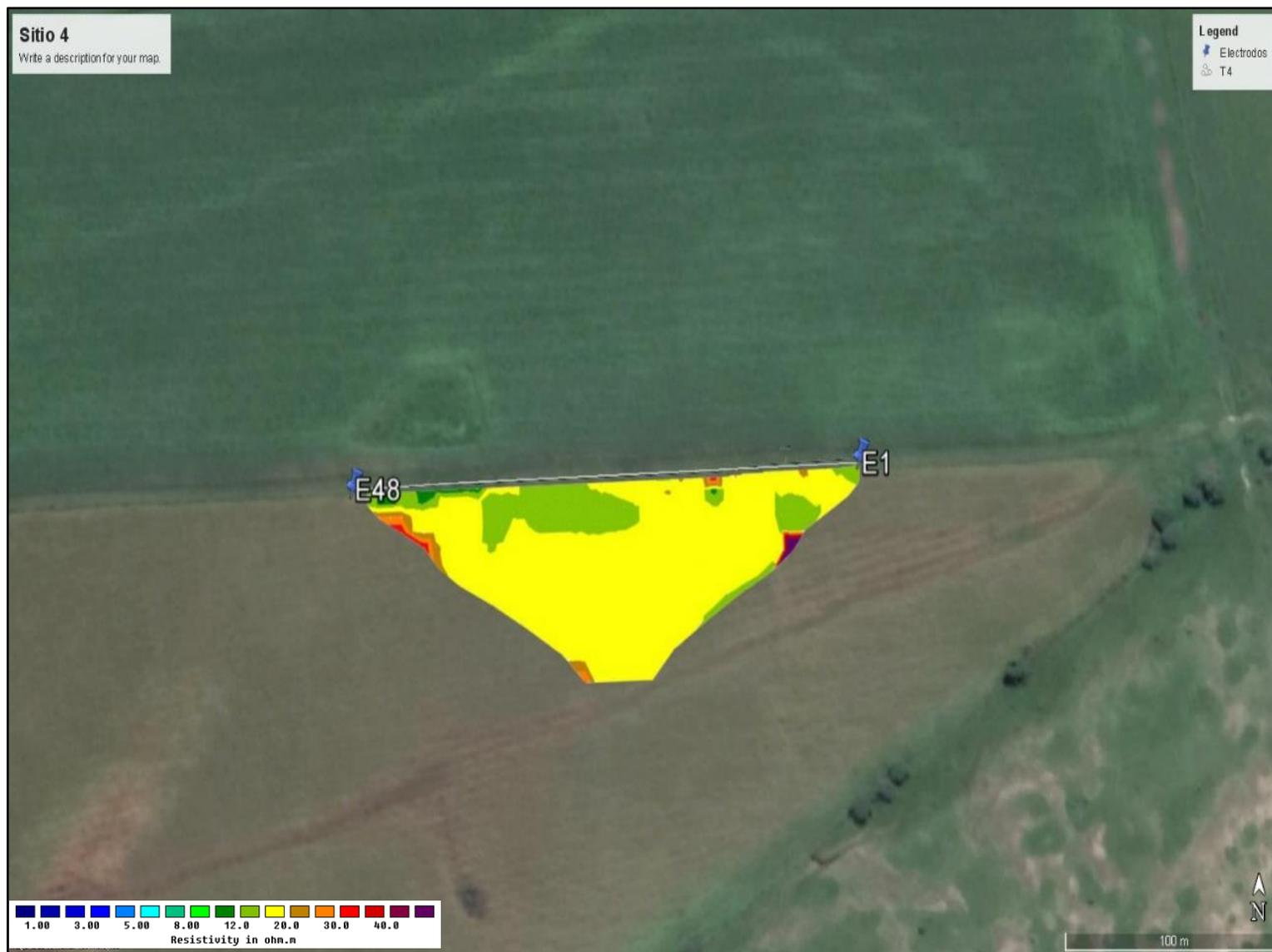
Figura 10-36: Resultado de ERT sitio 4, arreglo Wenner Alpha. Profundidad de relevamiento 50 m.
