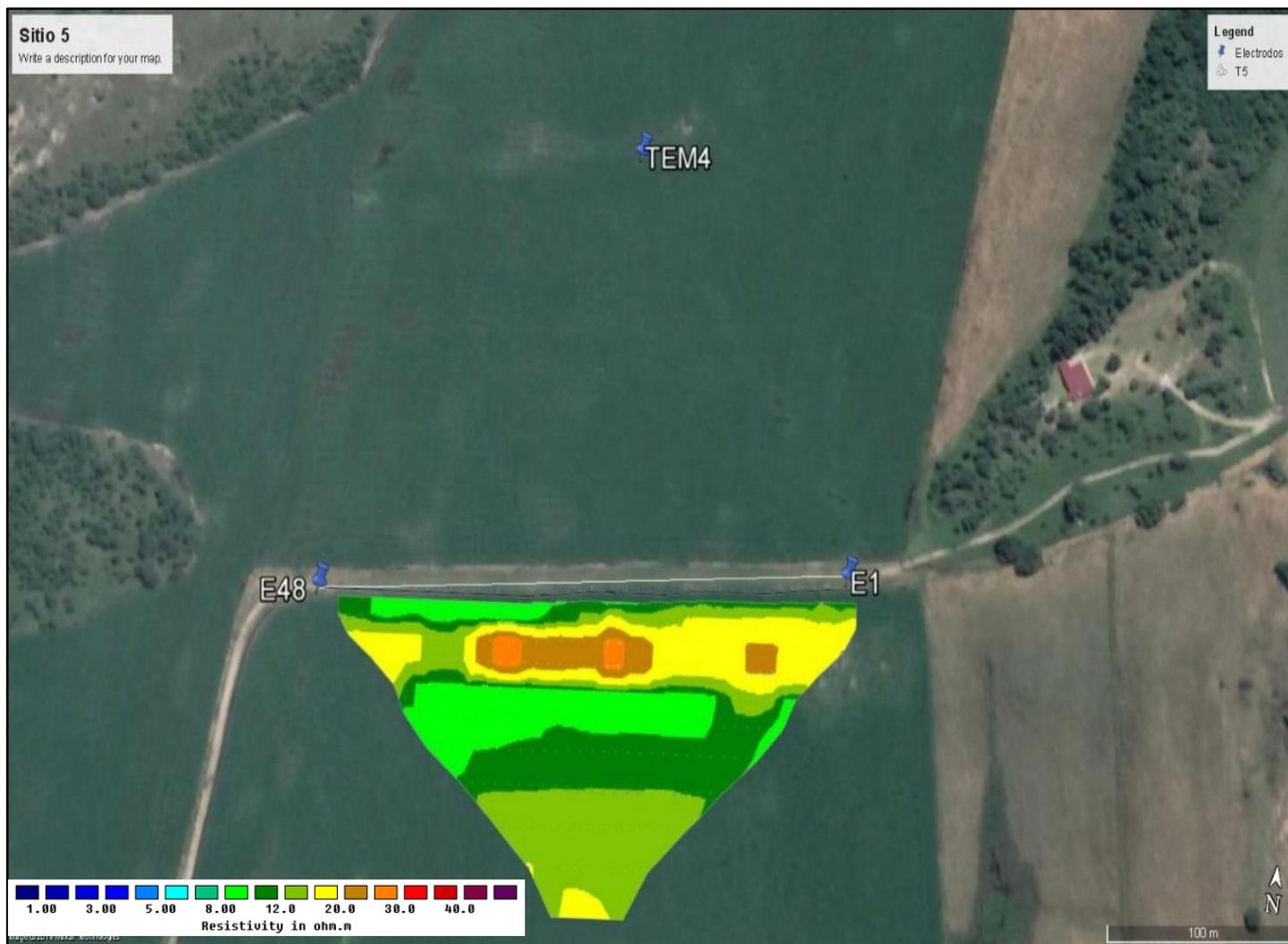
Figura 10-41: Resultado de ERT sitio 5, arreglo Wenner Alpha. Profundidad de relevamiento 60 m.
