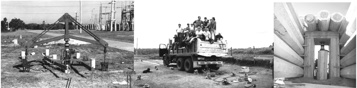
Figura 1. Dispositivos de ensayo a) pilotes de reacción, b) y c) carga muerta como reacción
