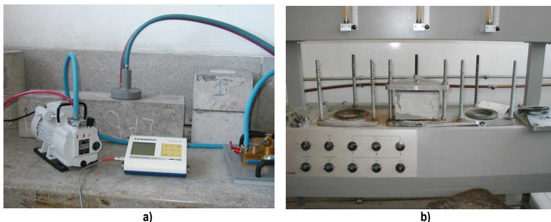
Figura 1. Equipos para la determinación de permeabilidad al aire (a) y al agua (b)
