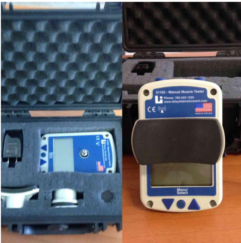
Figura 2. Instrumento para la medición de la fuerza de extensión (QMVC).
