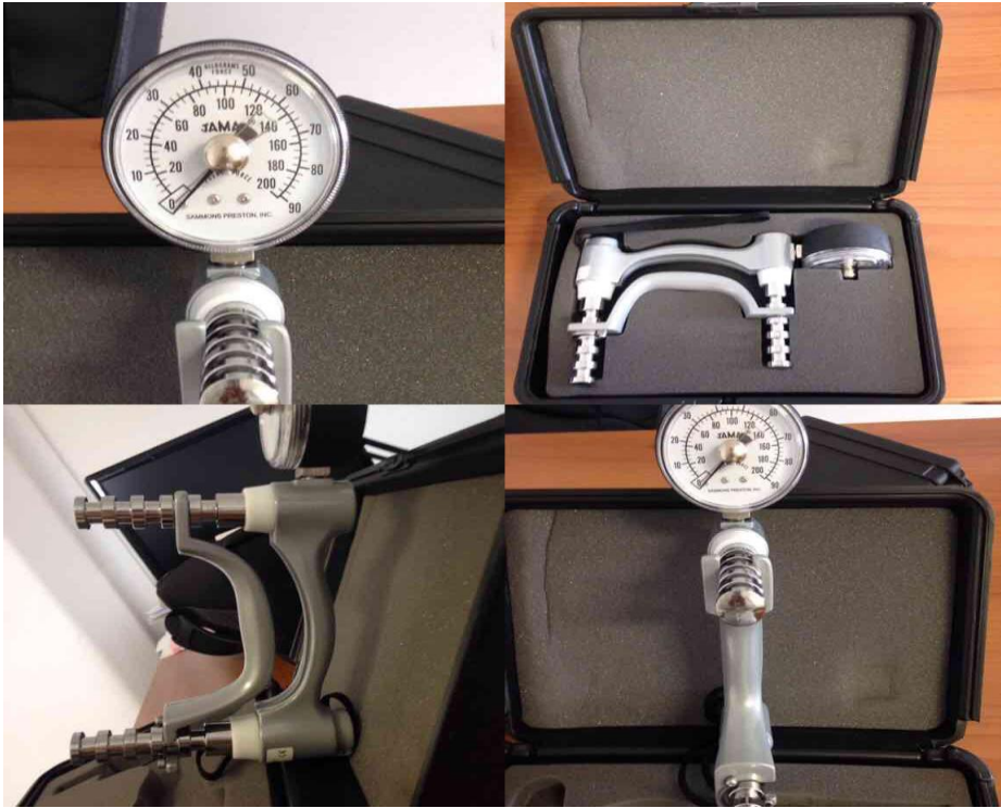
Figura 1. Instrumento para la medición de la fuerza de prensión (hand-grip).
