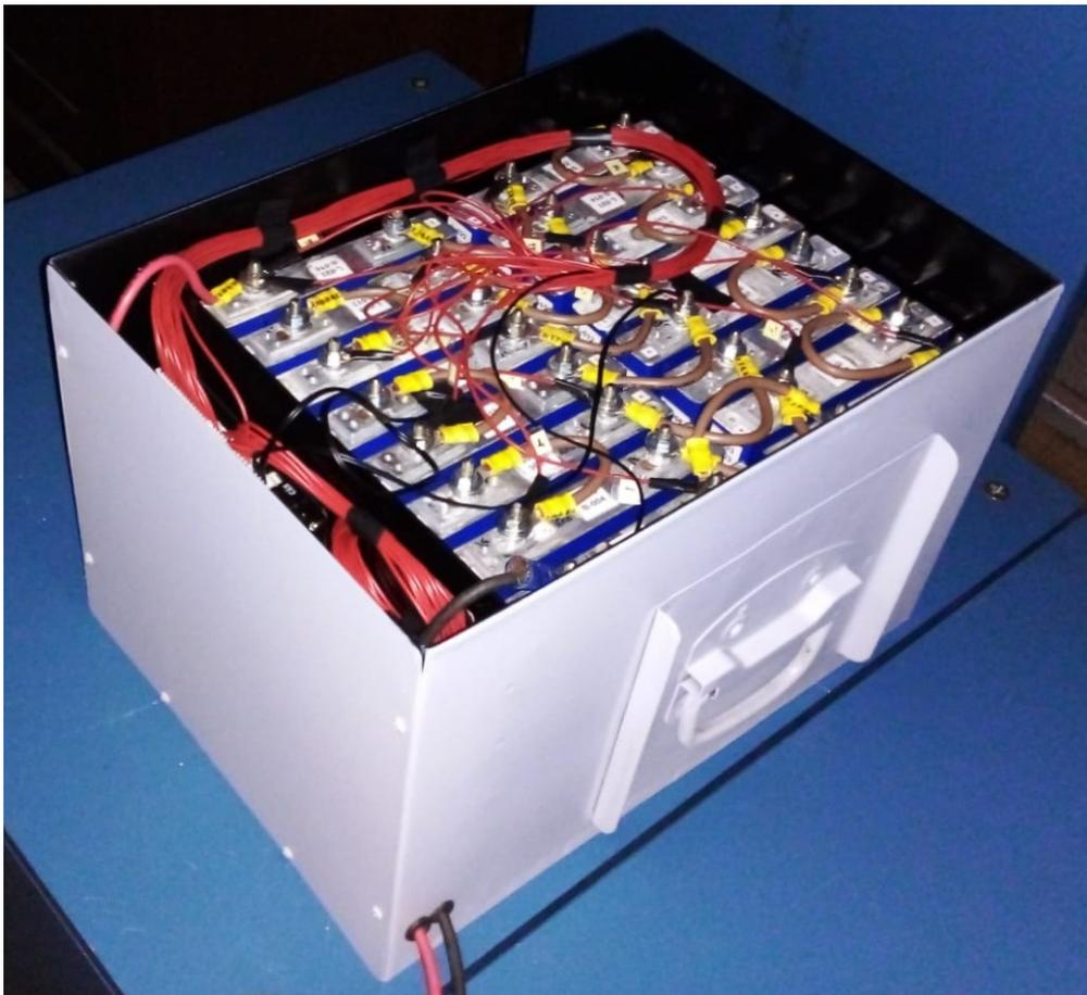
Figura C.32: Vista exterior del banco terminado con la tapa de acceso al BMS colocada.
