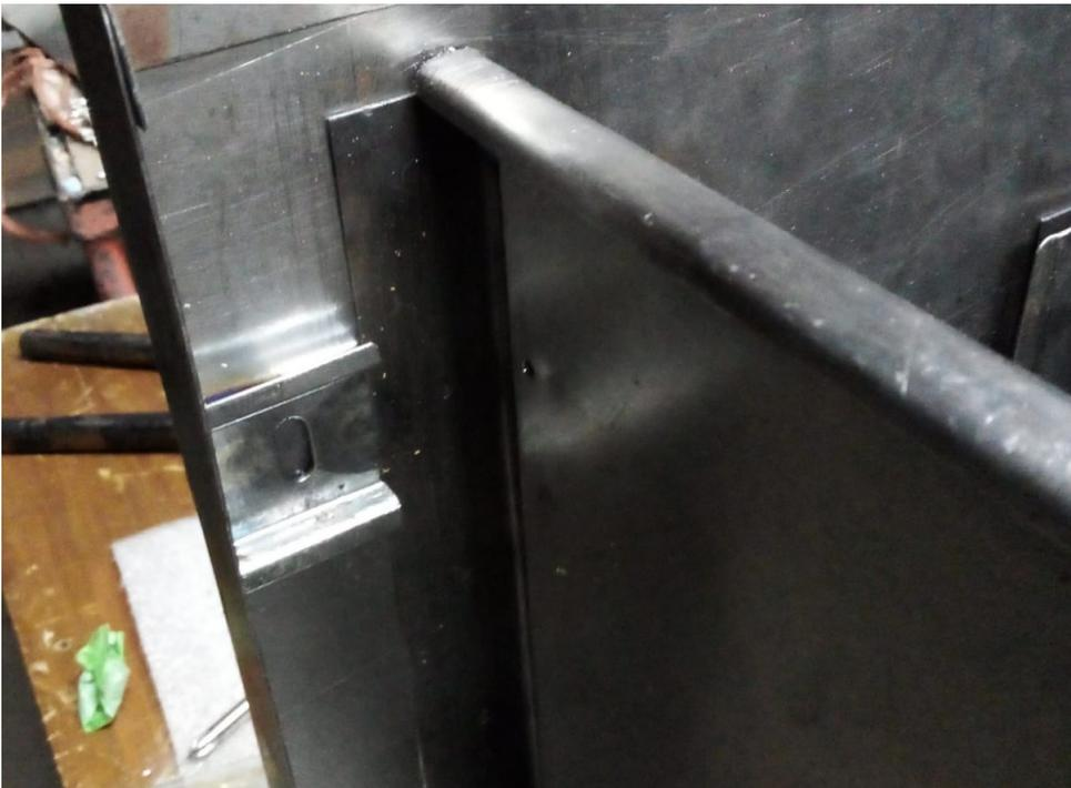
Figura C.21: Zócalo del BMS soldado al tabique separador de la cavidad BMS. Se sueldan tramos de riel DIN para colocar borneras.
