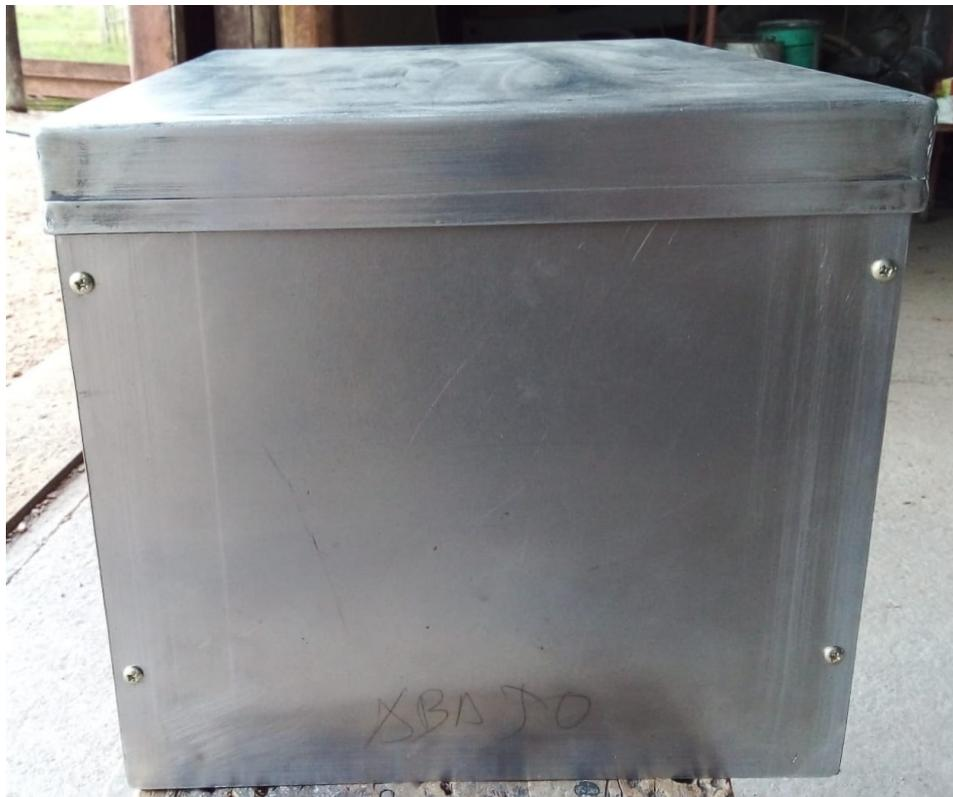
Figura C.23: Tapa lateral de acceso a la cavidad BMS colocada.
