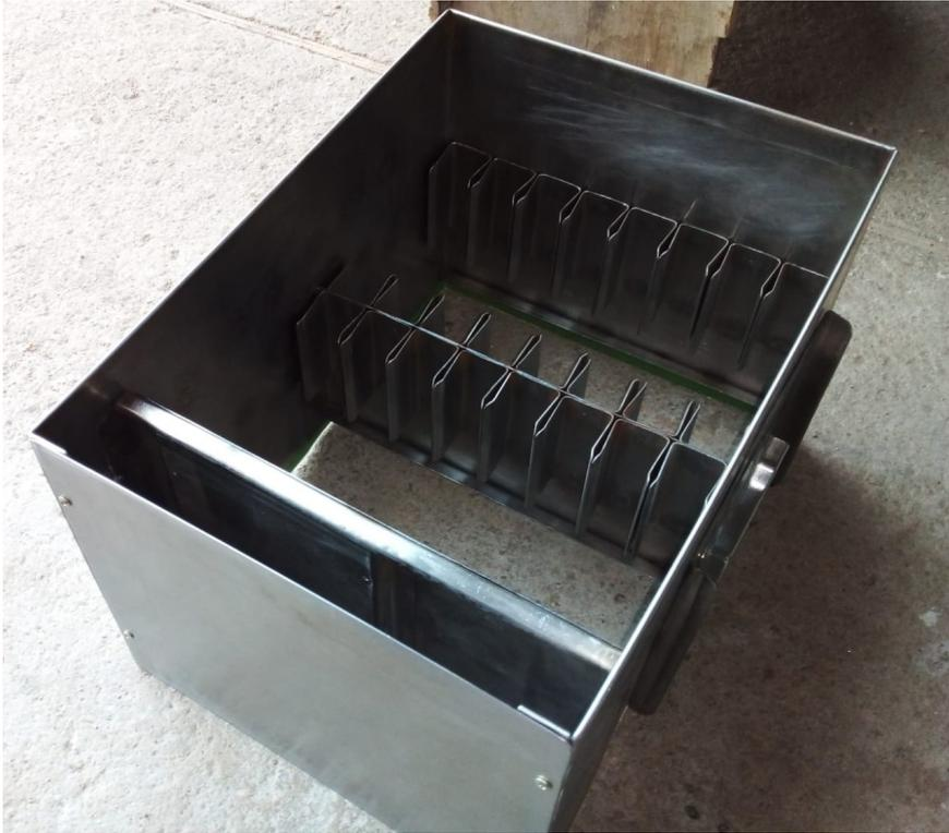
Figura C.24: Vista interior del gabinete con todas las piezas soldadas menos el fondo.
