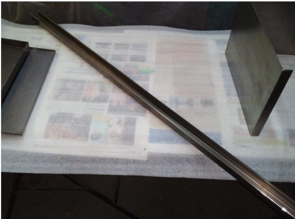
Figura C.11: Perfil "U" con el que se construyen las pinzas de sujeción de celdas.
