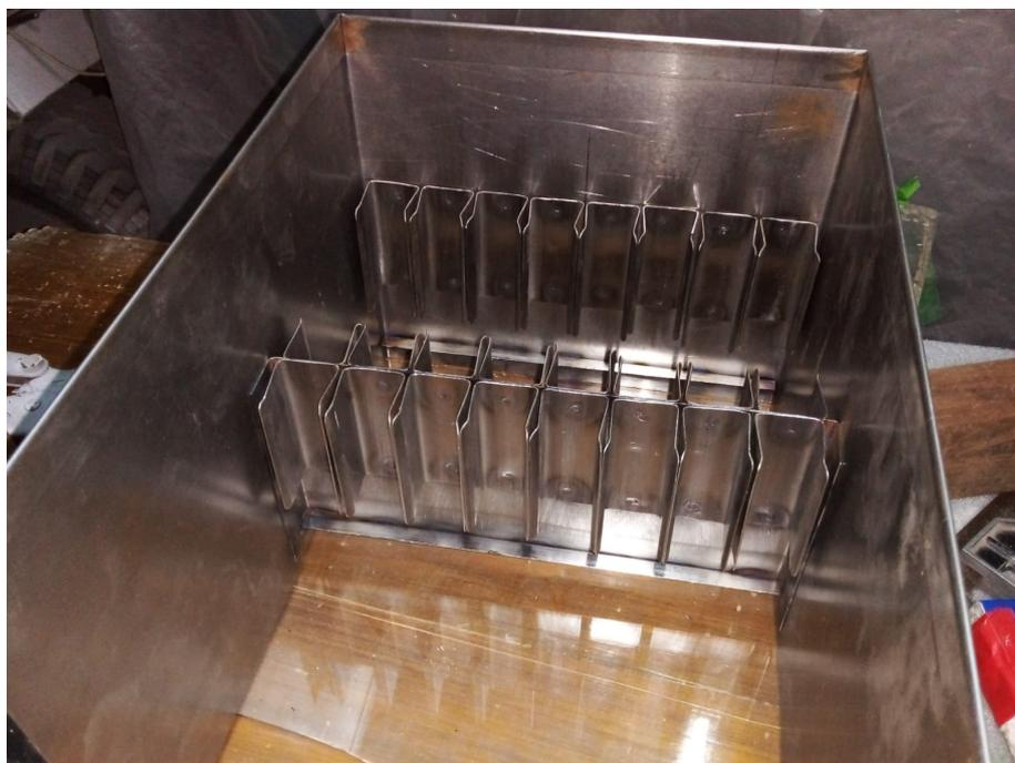
Figura C.18: Arriba: tabique separador de cavidad de celdas con todas las pinzas “U” de sujeción soldadas. Abajo: tabique separador soldado en el cuerpo del gabinete.
