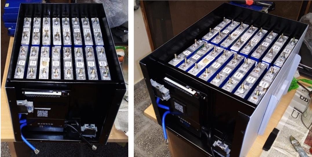
Figura C.29: Celdas colocadas dentro del gabinete, sujetadas por las pinzas de sujeción.
