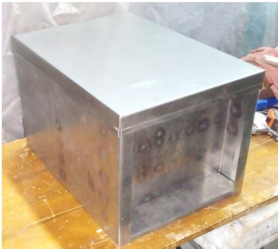
Figura C.20: Gabinete con tabiques soldados, pinzas de sujeción y tapa superior.
