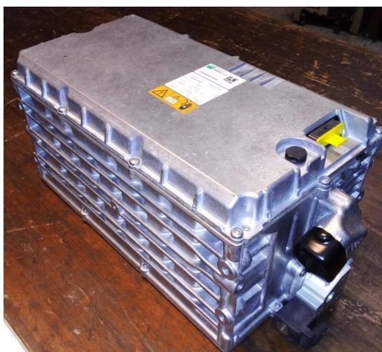
Figura 4.5: Batería de un vehículo híbrido marca Mercedes Benz, donada por Autolider Uruguay S.A.
