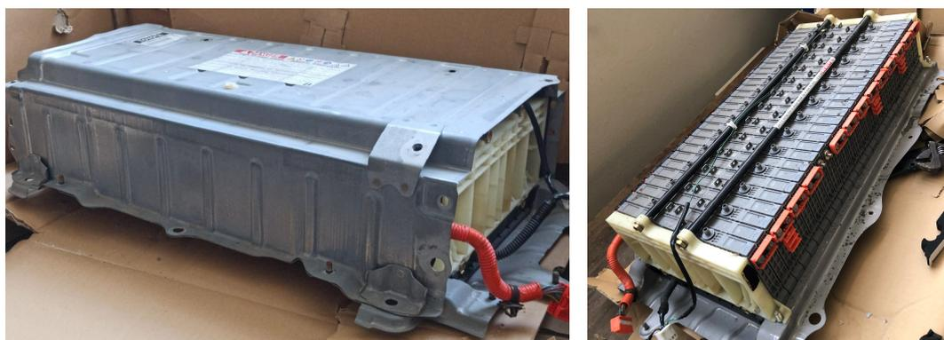
((a)) Batería con envoltura metálica.
