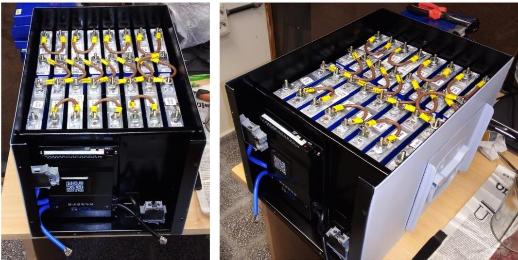
Figura C.30: Celdas colocadas dentro del gabinete y conectadas mediante cable de cobre de 6 mm<sup>2</sup>.
