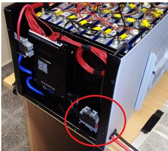
Figura 8.15: Punto de conexión de potencia del banco marcada con el círculo rojo.
