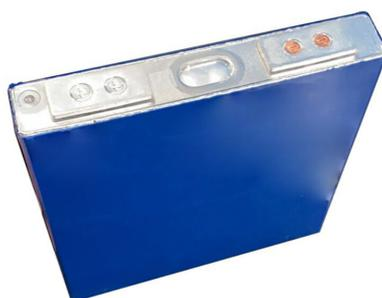
Figura 4.2: Una de las 24 celdas de LiFePO<sub>4</sub> que componen la batería donada por Mobility [28].
