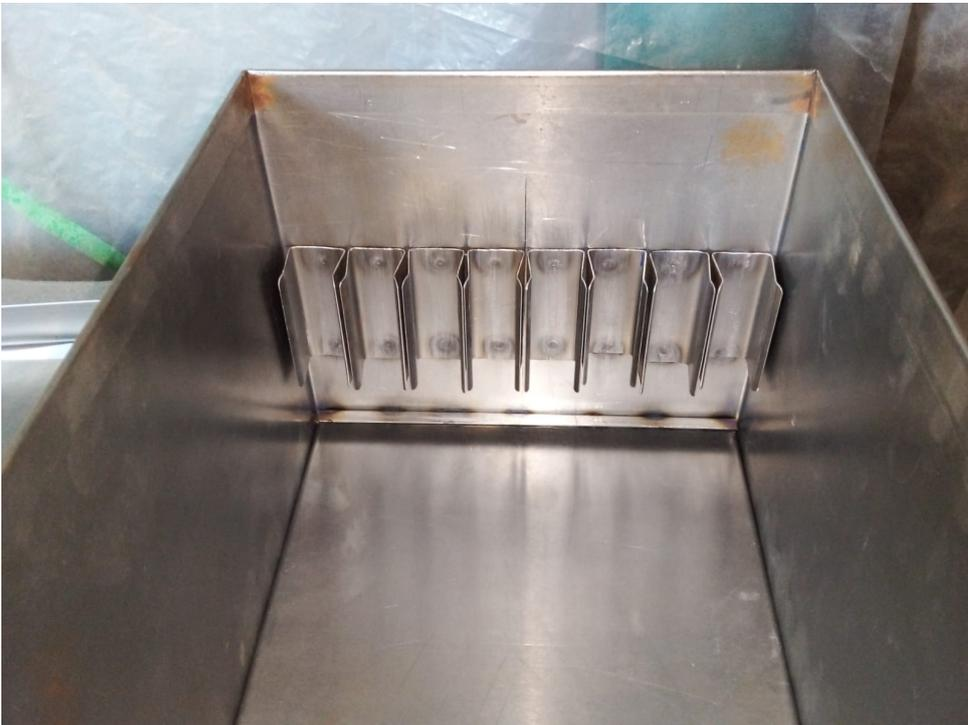
Figura C.17: Pinzas “U” de sujeción de celdas soldadas en una de las caras del cuerpo del gabinete.
