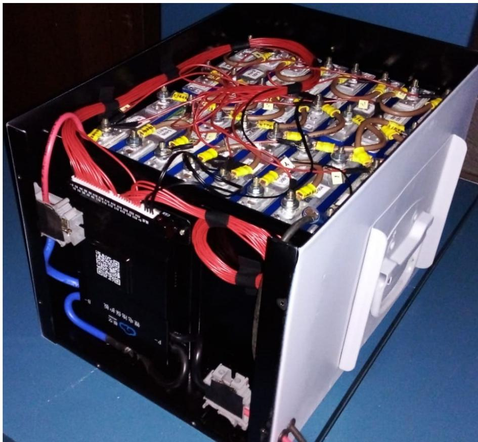
Figura 7.1: Banco de baterías construido. Se observan las 16 celdas interconectadas dentro del gabinete contenedor y el BMS con sus respectivas sondas de tensión conectadas a las celdas. Para facilitar la visión de los componentes, se extrajo la tapa superior y la tapa lateral.
