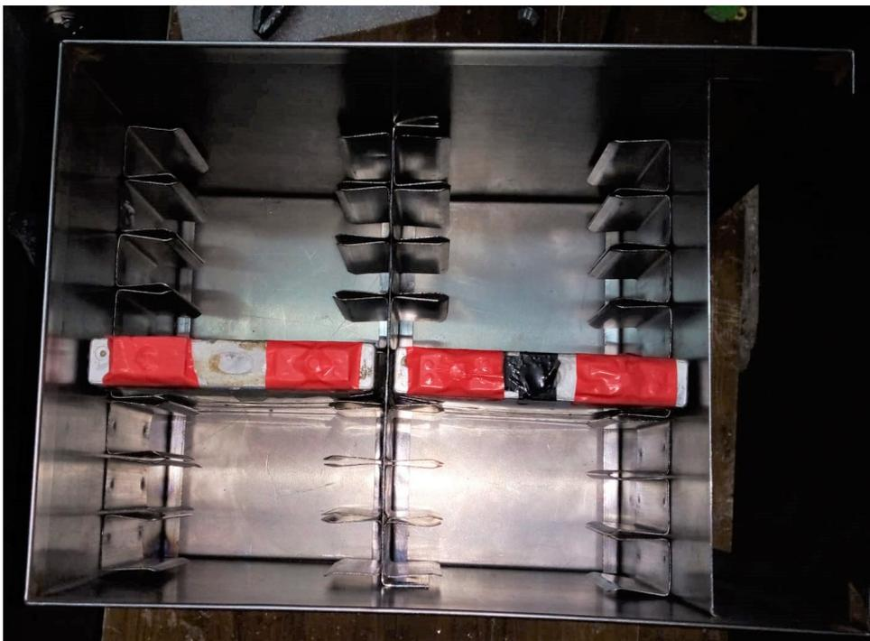
Figura C.19: Todos los tabiques separadores soldados con sus respectivas pinzas "U" de sujeción. Se colocan dos celdas de referencia para realizar las soldaduras a medida.
