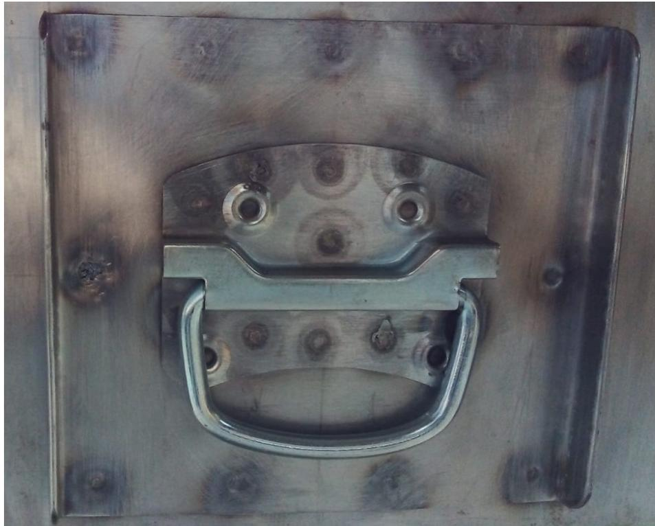
Figura C.22: Manijas soldadas en las caras exteriores del gabinete para facilitar su transportación.
