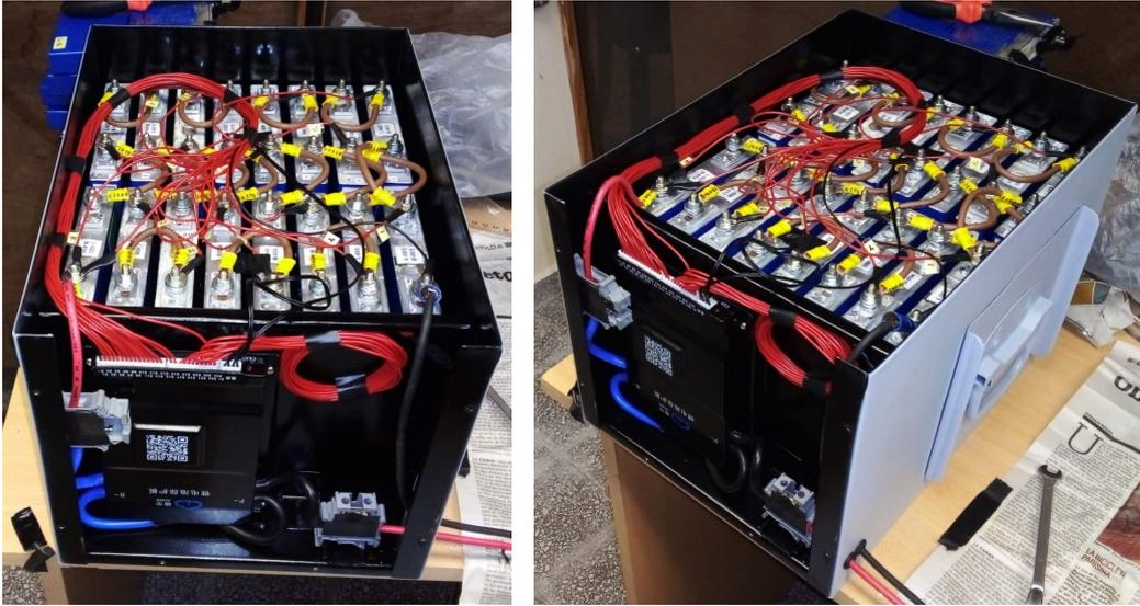
Figura C.31: Celdas colocadas dentro del gabinete con BMS instalado y conectado.
