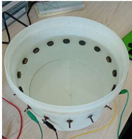
Figura C.4: Fantoma utilizado para las medidas manuales de los potenciales en los electrodos. Fantoma construido en proyectos IMPETOM anteriores que fue reutilizado.
