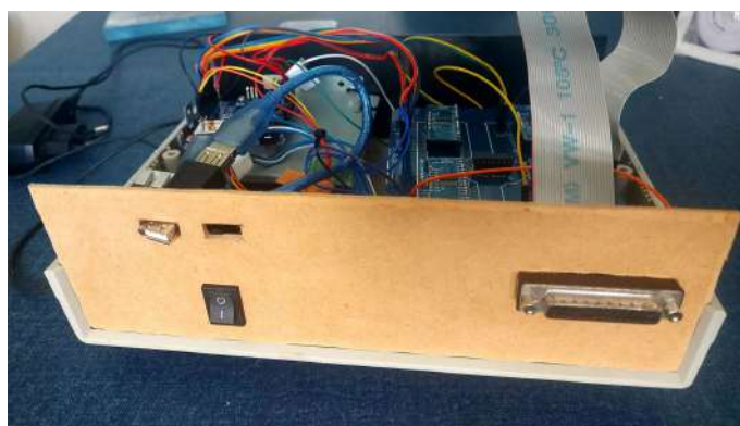
Figura G.3: Caja abierta de IMPETOM-Clínico en proceso de armado. Imagen previa al sellado de los conectores USB, colocado de la luz LED, puesta de la Power Bank y pintado de la tapa.
