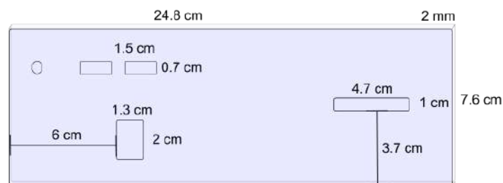
Figura G.1: Medidas de la cara delantera para la caja de IMPETOM-Clínico. Notar que las medidas no están hechas a escala, referenciarse con las medidas escritas.
