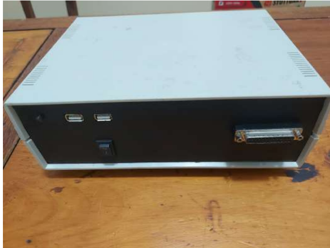
Figura G.4: Caja de IMPETOM-Clínico. Imagen del exterior de la caja una vez terminado el armado. En su interior se encuentran realizadas todas las conexiones necesarias para su funcionamiento. Notar en la cara delantera un conector USB para la conexión con la PC (adquisición de datos) y el otro conector USB para la energización del equipo. Un switch On/Off para el encendido/apagado del equipo con una luz LED de color azul en el extremo izquierdo superior que muestra su estado. El conector DB-25 es para la conexión con el cable de 16 electrodos al paciente.
