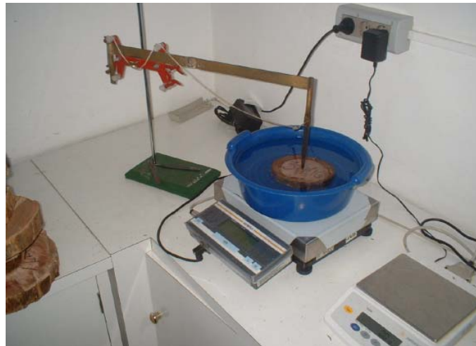
Figura No. 4. Determinación de volumen
