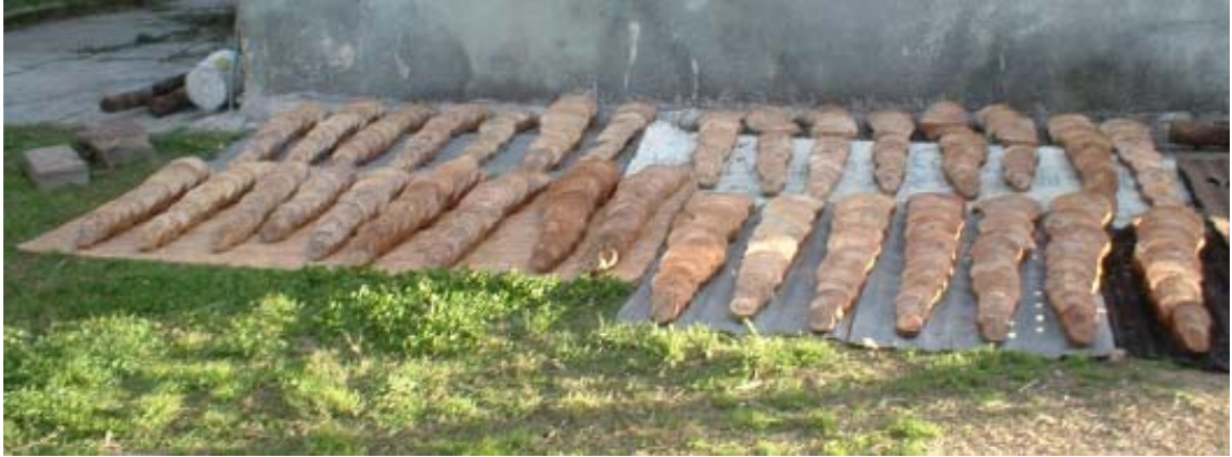
Figura No. 5. Secado de las muestras al aire libre
