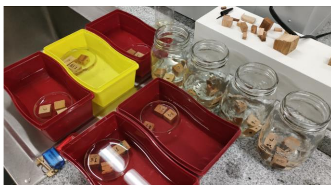
Figura 46. Probetas de estabilidad dimensional sumergidas en agua destilada.
