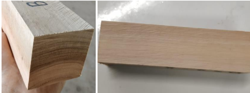
Figura 40. Izquierda: probeta con una adecuada orientación de los anillos de crecimiento. Derecha: fibras paralelas a los cantos.
