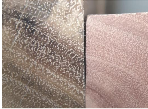
Figura 77. Corte transversal. Observación a lupa de vasos. Izquierda: Muestra de E. bosistoana . Derecha: Muestra de la troza 1 (otra especie).
