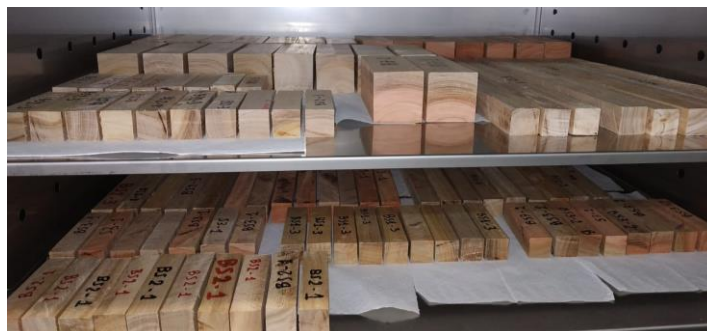
Figura 41. Probetas en cámara de climatización.
