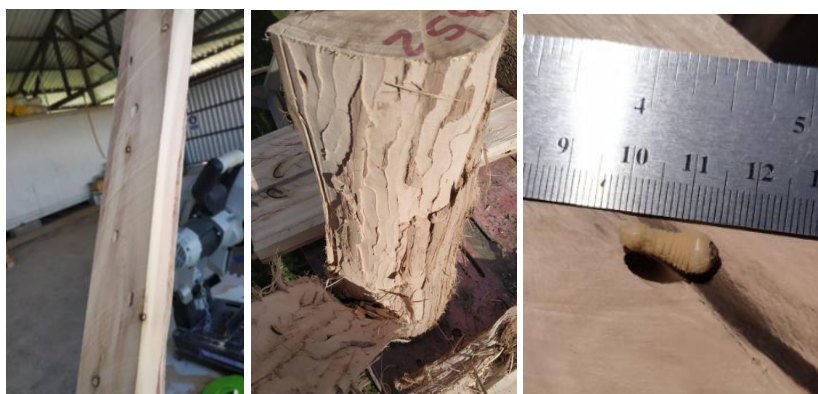
Figura 56. Se observan las galerías dentro del fuste, además de una larva viva.
