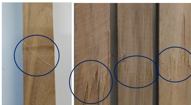
Figura 65. Izquierda: Detalle de la falla por compresión. Derecha: Falla tipo “splintering” en zona bajo tracción.
