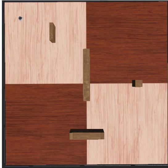
Figura 3.24: Representación en Webots del mapa mostrado en la figura 3.3a. En la parte superior izquierda se encuentra el Khepera III en su posición inicial.
