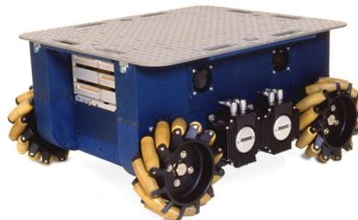
Figura 2.4: El robot Uranus, de la Universidad Carnegie Mellon, es un robot impulsado por 4 ruedas independientes omnidireccionales. [3]
