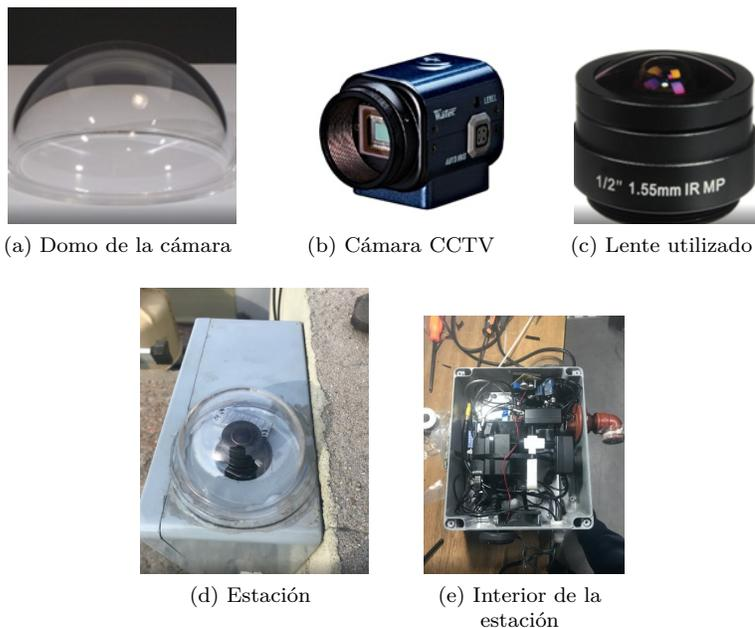
Figura 1.1: Elementos, estación e interior de Prototipo 1.
