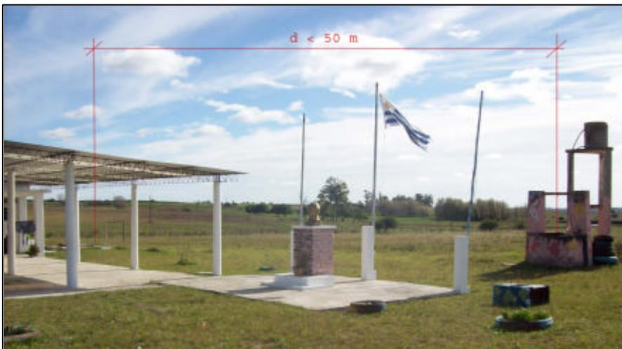
**Distancia entre punto de extracción de agua para consumo y pozo filtrante menor a 50m**
