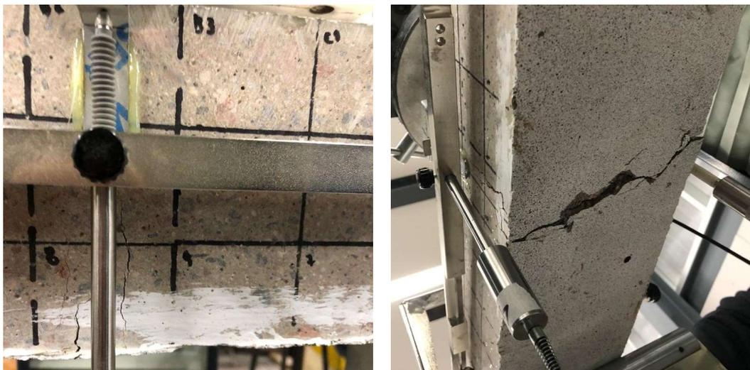
Figura 3–4 Fisura en cara lateral (Izq.) - Fisura en cara inferior (Der.)
