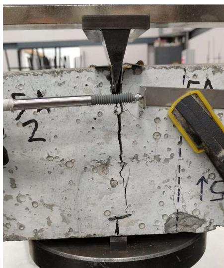
Figura 4-2 Posición de LVDT en ensayo MVD.
