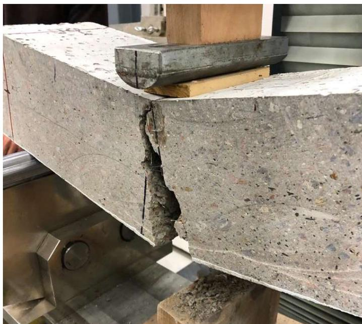
Figura 3–5 Momento de rotura de testigo en ensayo a flexión.
