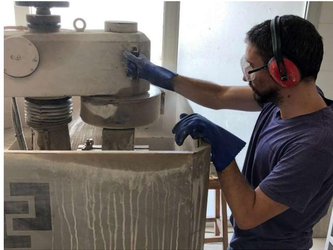
Figura 4-10 Pulidora para testigo extraído
