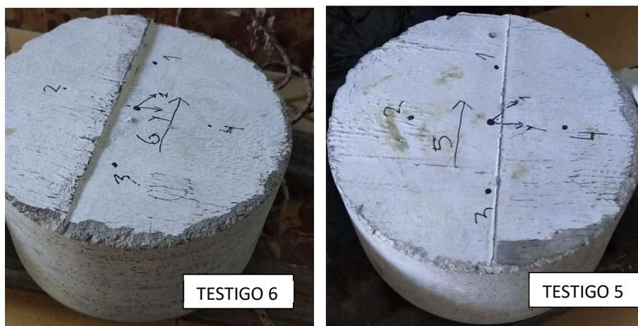
Figura 4-7 Defectos en testigos 6 y 5, cara inferior
