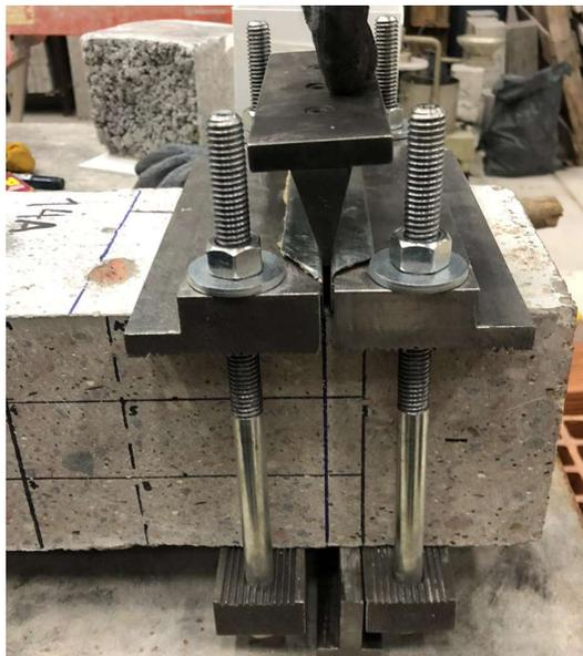
Figura 9-3 Foto del dispositivo para el ensayo Montevideo modificado.
