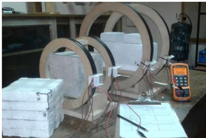
*Figura 2-10 Bobinas construidas en el IET (Cañette et al., 2017).*
