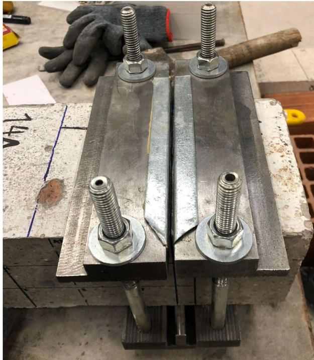
Figura 9-2 Dispositivo para realizar el ensayo Montevideo Modificado.
