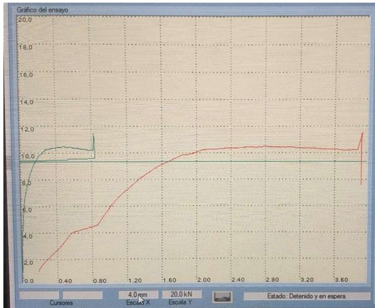
Figura 9-7 Gráfico donde se puede apreciar el deslizamiento de la pieza
