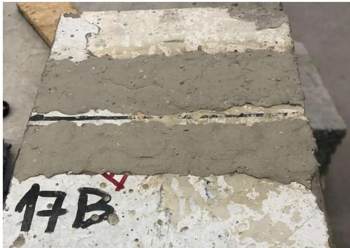
*Figura 9-10 Testigo con Poxilina para mejorar el rozamiento con la pieza metálica.*
