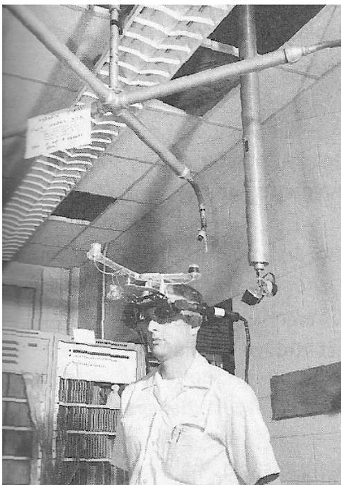
Fig.f. Usuario haciendo uso del dispositivo. Se puede observar el soporte al que se monta del techo. <sup>f</sup>
