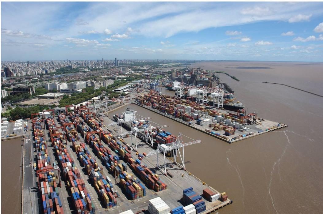
Figura 1.2.6. Puerto de Buenos Aires, en el que se identifican claramente 2 terminales con sus correspondientes espacios de almacenamiento de contenedores y grúas pórtico
