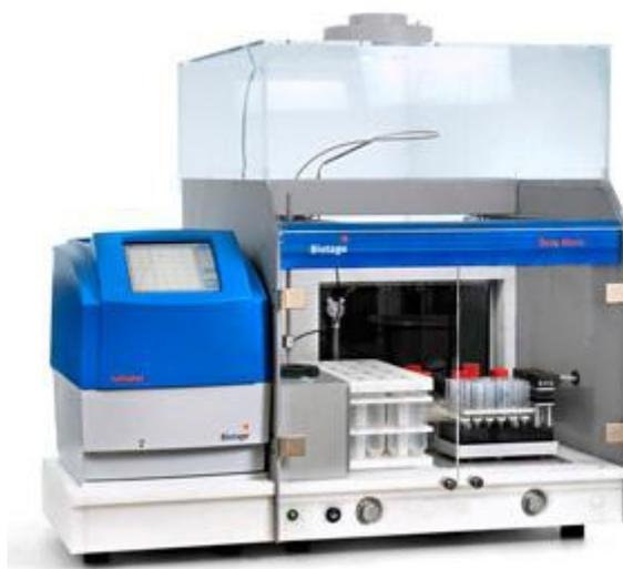
**Figura 4.3** Sintetizador automático de péptidos acoplado a microondas
