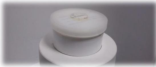
**Figura 21:** Corrección por autoabsorción: geometría de 100 mL, dispositivo colimador y fuente de  $^{241}\text{Am}$
