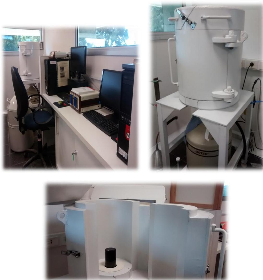
**Figura 24:** Sistema de espectrometría gamma ORTEC- AMETEK GMX35P4-76-RB con detector de Germanio de alta pureza (HPGe) y su blindaje de plomo
