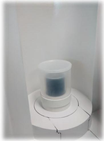
**Figura 10:** Recipiente utilizado para cuantificación por espectrometría gamma con geometría tipo Marinelli, colocado sobre el detector de alta pureza (HPGe)
