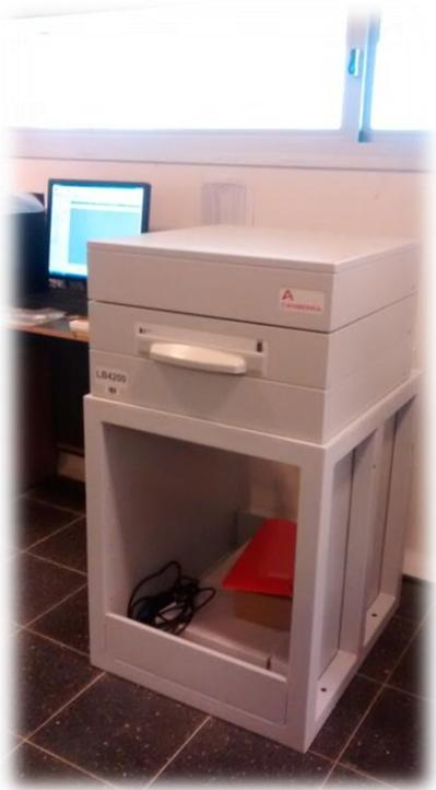
**Figura 25:** Sistema contador proporcional alfa y beta total de bajo background CANBERRA LB4200
