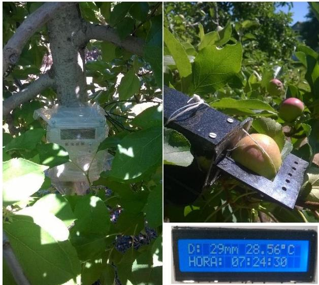
Figura No. 1. Calibre fijo o dendrómetro
