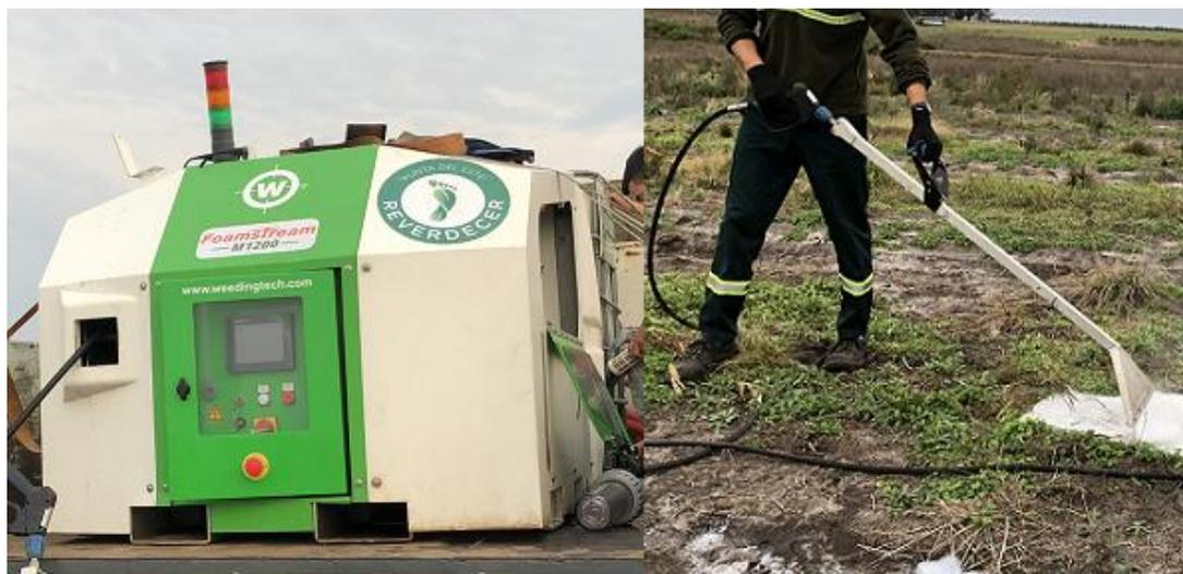
Figura No. 7. Equipo utilizado para aplicación de agua caliente
