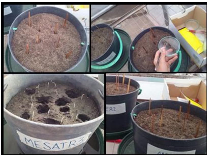
Figura No. 4. Macetas conteniendo los 8 puntos utilizados para estimar el contenido de clomazone en suelo
