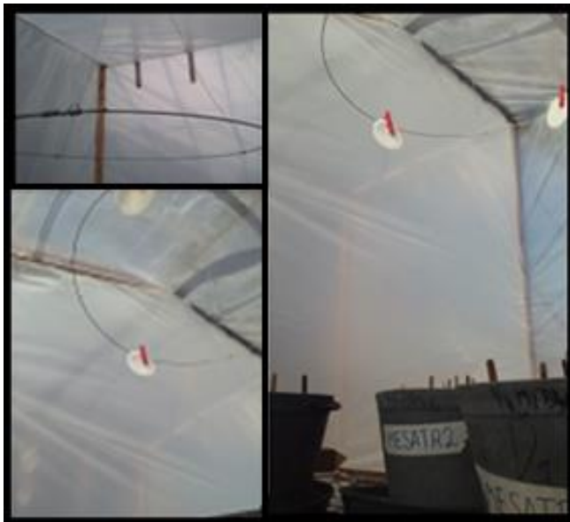
Figura No. 3. Diseño del soporte y posición de los muestreadores de clomazone en aire
