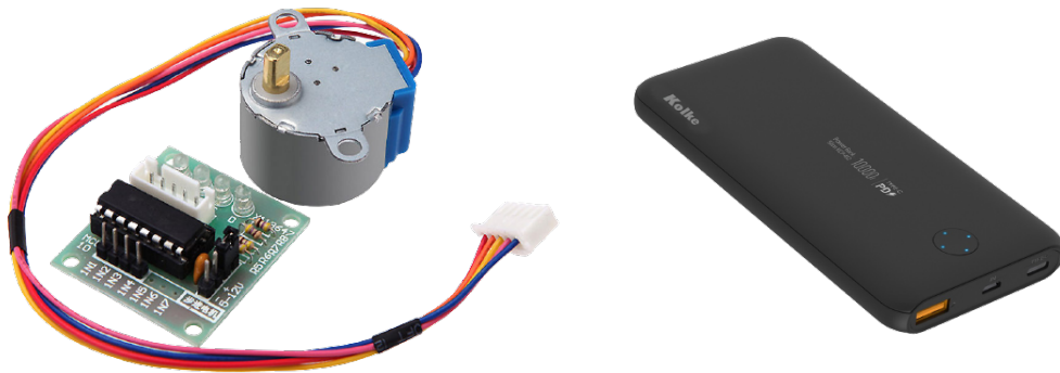
(a) Motor 28BYJ-48 y driver ULN2003A
