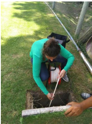
Fig. 34 Pozo donde se pudo recabar nivel piezométrico, no presenta bomba (se había quemado), por tanto, se encontraba abierto. El mismo es un segundo pozo perteneciente al Complejo Deportivo Devoto, Club Náutico.
