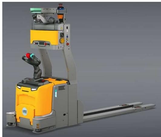
Figura 43. Transpaleta auto guiada modelo ERE 225 y marca Jungheinrich. (Fuente: Jungheinrich)
