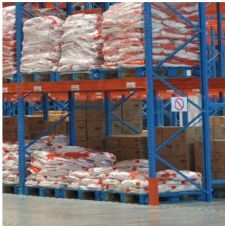
Figura 30. Rack simple profundidad. (Fuente: Elaboración propia)
