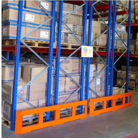
Figura 29. Rack doble profundidad. (Fuente: Elaboración propia)
