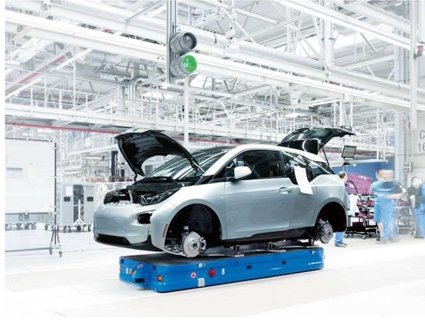
Figura 6. Vehículos de línea de ensamble (Fuente: dpm)
