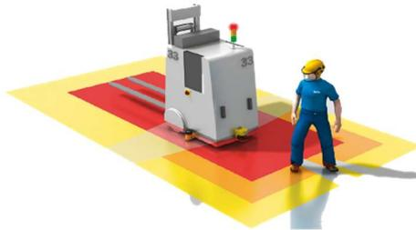
Figura 9. Campos de seguridad (Fuente: Robos)
