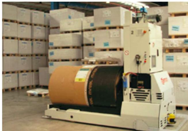
Figura 17. AGV utilizados para la manipulación de rollos de papel (Fuente: Egemin, Ullrich)
