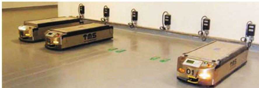
Figura 12. Estaciones de carga de AGV (Fuente: DS, Ullrich)
