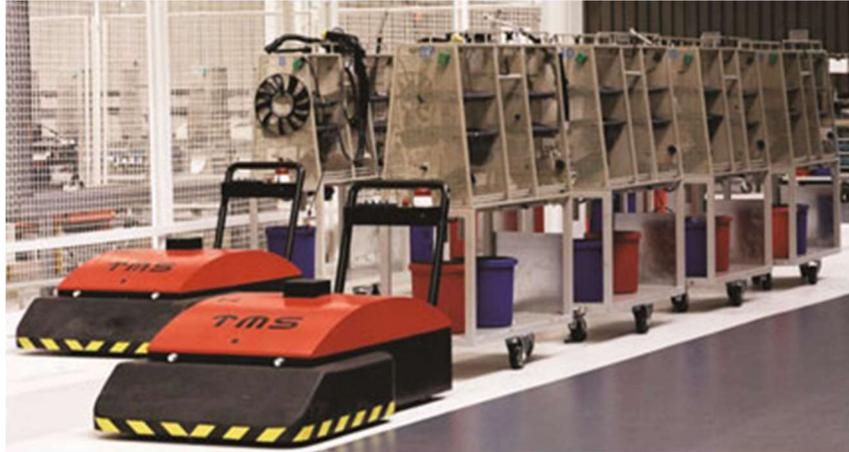
Figura 16. AGV utilizado como trailer en la industria automotriz (Fuente: DS, Ullrich)
