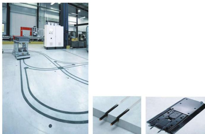
Figura 11. Sistema de carga por inducción. (Fuente: SEW, Ullrich)
