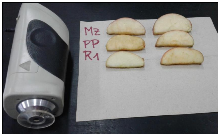
Figura 5. Medición del color en cascos de Oregon Spur con colorímetro digital
