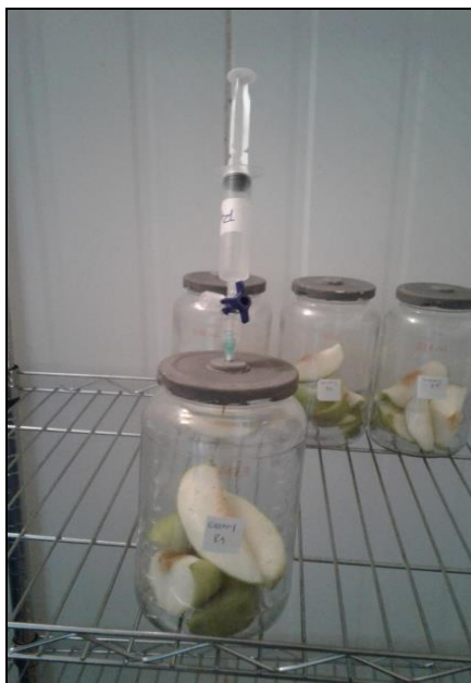
Figura 4. Extracción de gas del espacio de cabeza de frascos herméticos con cascos de Granny Smith
