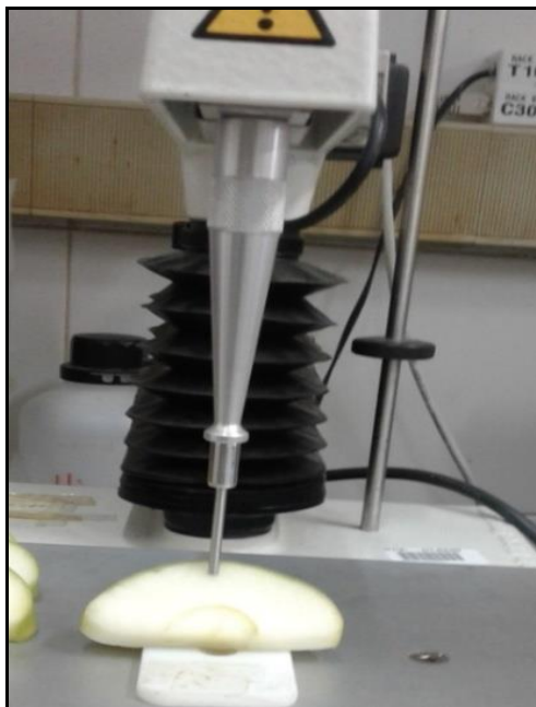
Figura 6. Medición de la firmeza en cascos de Granny Smith utilizando texturómetro
