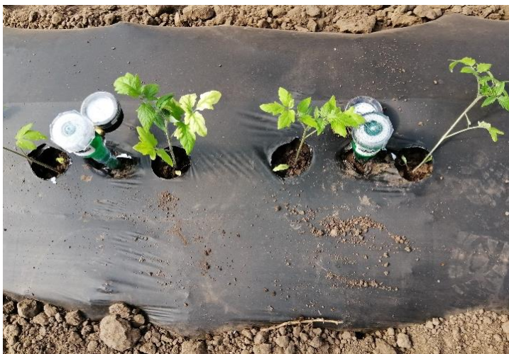
Figura No. 5. Fotografía de una de las dos parcelas en las que se instalaron 2 tensiómetros, el de a derecha a 30 cm y el de la izquierda a 20 cm de profundidad
