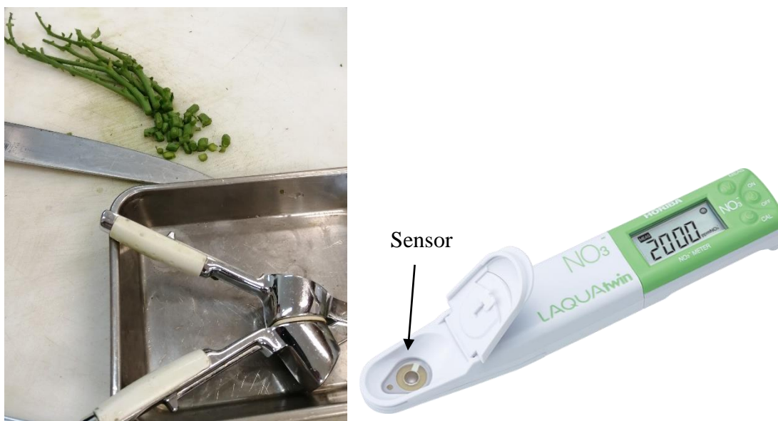
Figura No. 8. A la izquierda trozos de pecíolo y prensa de ajo utilizada para extraer la savia. A la derecha electrodo selectivo de iones LAQUAtwin \text{NO}_3^- marca HORIBA
