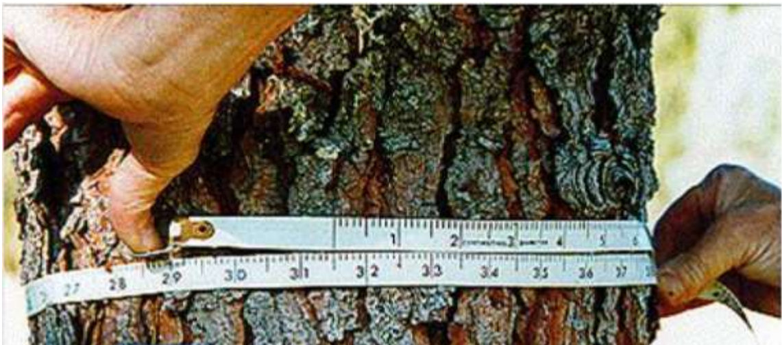
Figura No. 15. Medición de diámetro con cinta.
