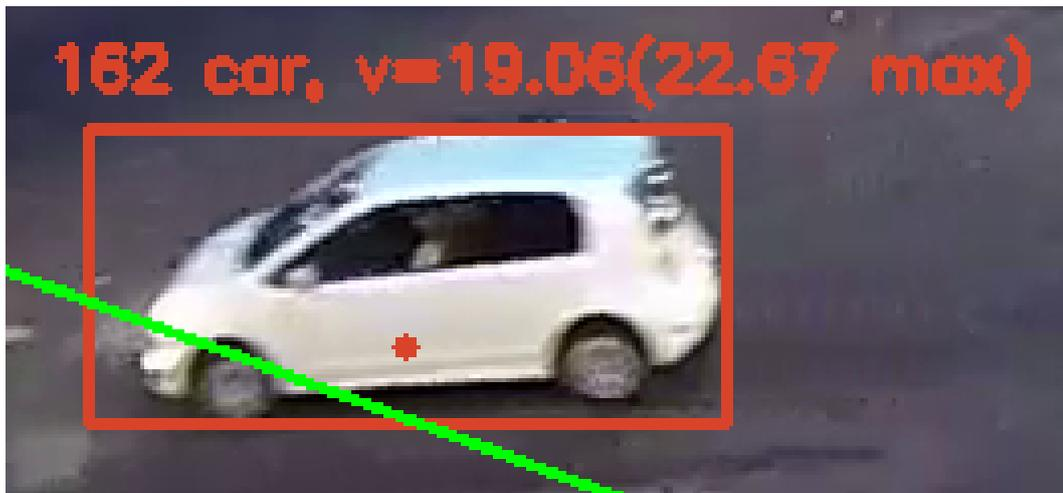
**Figura 3.36:** Vehículo con punto representativo situado a 0,25 del borde inferior de su bounding box.
