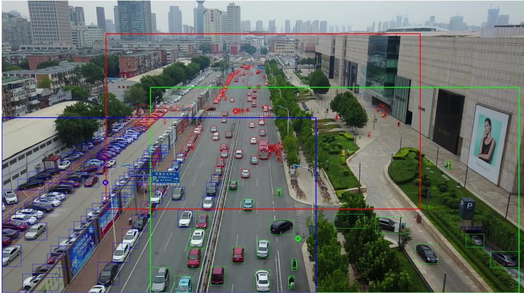
**Figura 3.5:** Ejemplo de preprocesamiento sobre imagen de Visdrone, donde los rectángulos de color verde, rojo y azul representan las imágenes ampliadas correspondientes a cada cluster.
