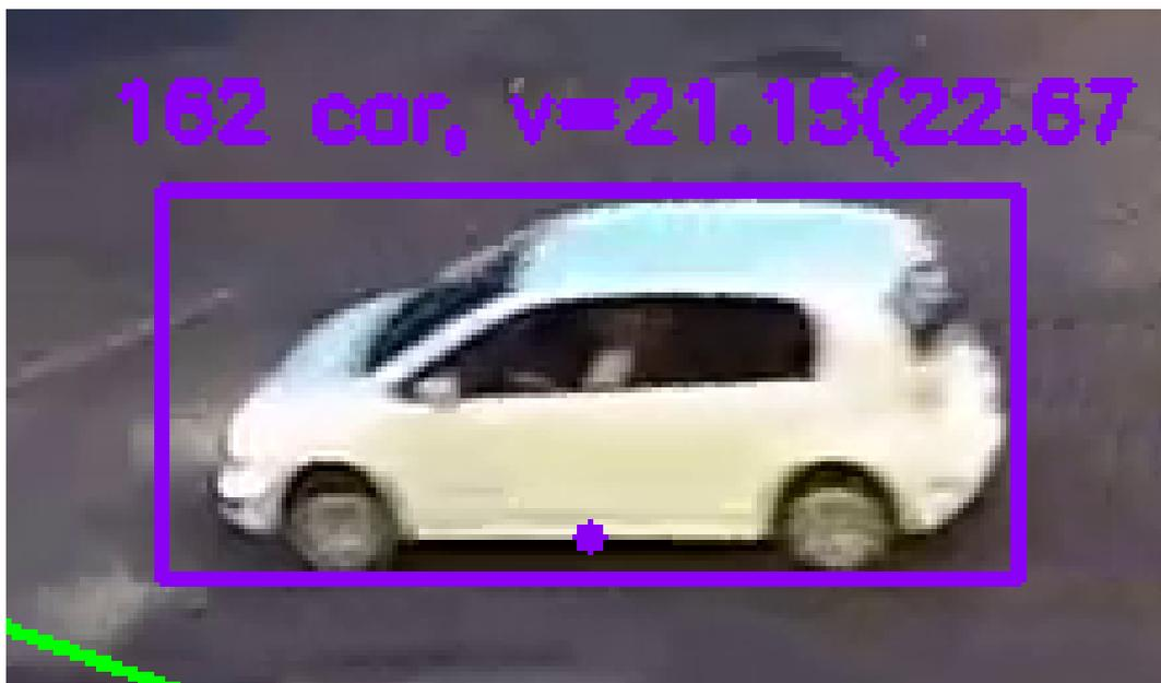
**Figura 3.37:** Vehículo con punto representativo situado a 0,1 del borde inferior de su bounding box.
