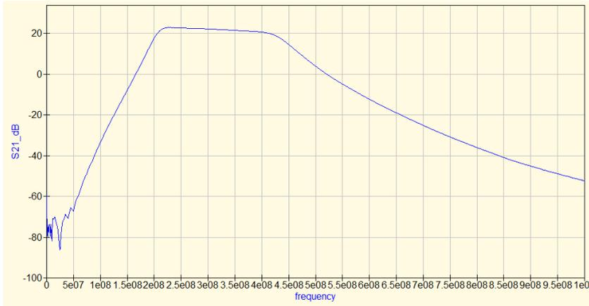
Figura 5.4: Simulación software QUCS LNA-LPF-HPF
