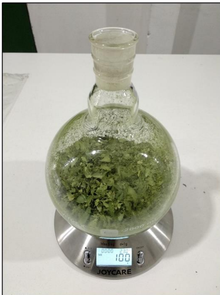
Figura 9. Balón de vidrio con hojas de pitanga molidas para su posterior destilación.
