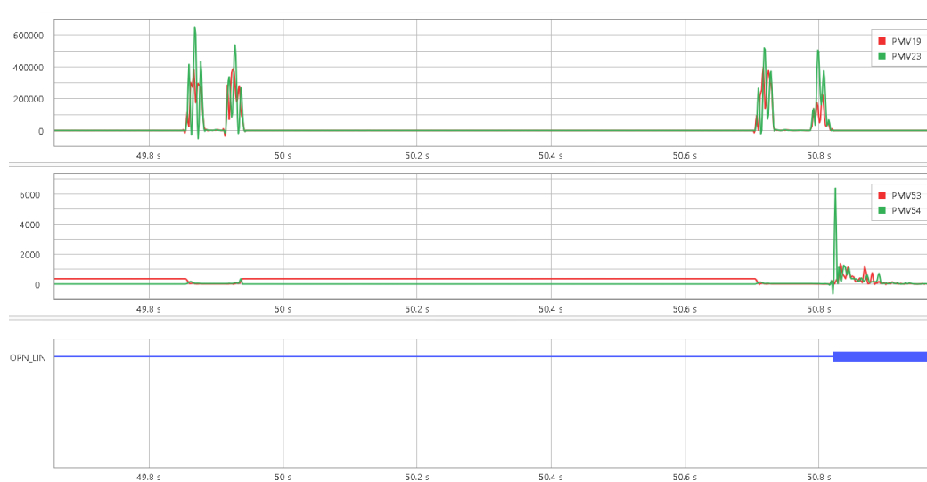
Figura 7.16: Valores de filtro Delta y RX durante la falla 1FT simulada con recierre fallido en la línea de Brujas - Montevideo B
