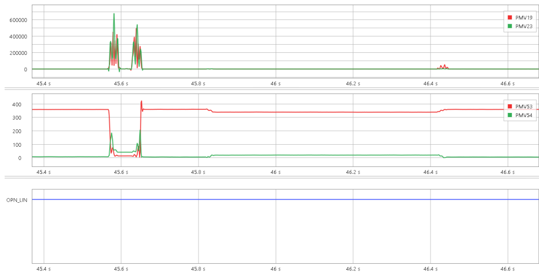
Figura 7.14: Valores de filtro Delta y RX durante la falla 1FT simulada con recierre exitoso en la línea de Brujas - Montevideo B
