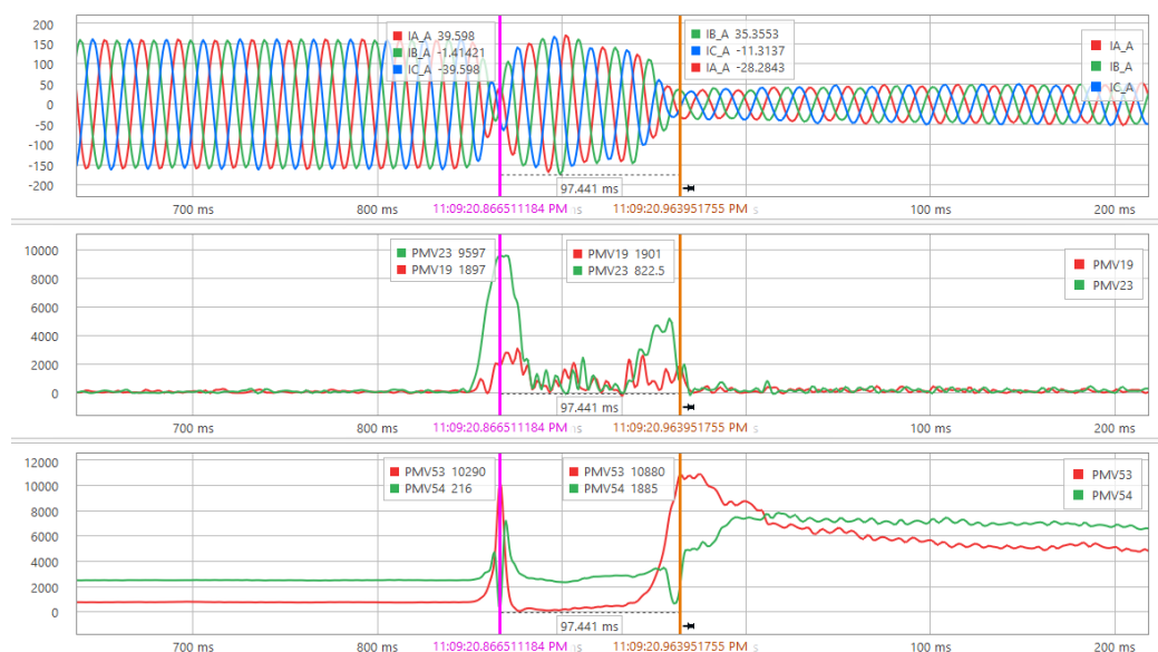
Figura 7.26: Inversión real; en la imagen superior se muestran las corrientes por la línea; imagen central \Delta P en rojo (PMV19) y \Delta Q en verde (PMV23); imagen inferior R_d en rojo (PMV53) y X_d en verde (PMV54).
