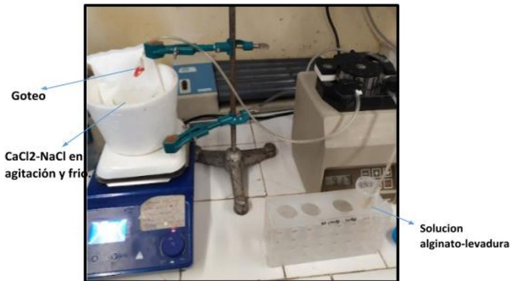
**Figura 5.** Procedimiento de la inmovilización en perlas de alginato de calcio.
