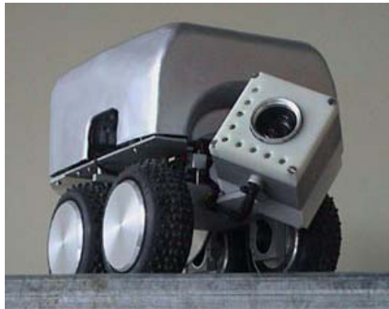
Figura 34: vista del robot inspector de conductos de aire
