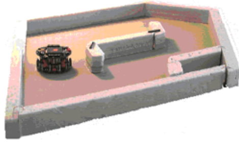
Figura 25: entorno propuesto para navegación reactiva
