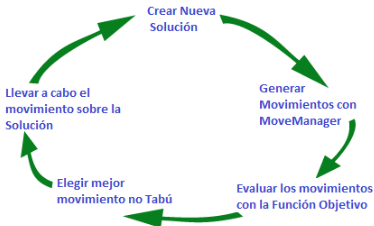
Figura 4.18 – Esquema de ejecución de OpenTS
