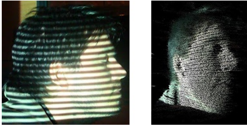
Figura 4.1: Izq: Patrón proyectado sobre sujeto de prueba. Der: Nube de puntos obtenida
