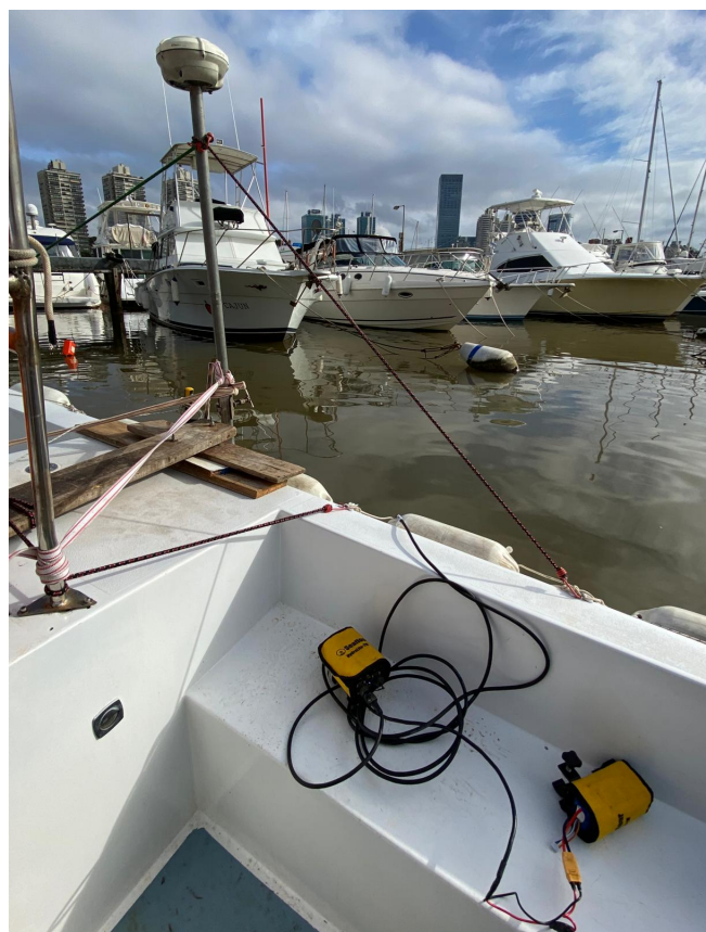
Figura 35: Bastón con antena GNSS amarrada a la embarcación, transductor sumergido y ecosonda conectada.
