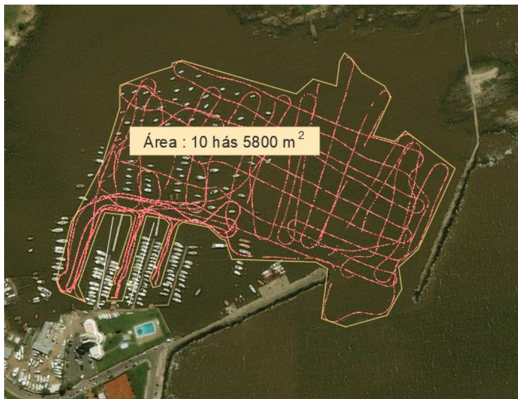
Figura 41: Levantamiento batimétrico ejecutado.
