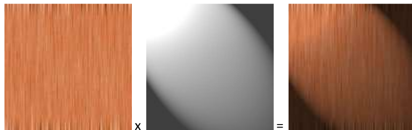
Figura 8 Una textura, multiplicada por un Lightmap da la imagen final iluminada (10)
