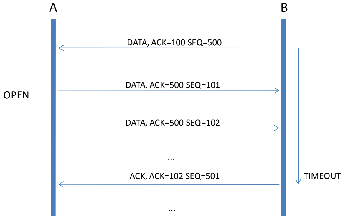
Figura 32 Mensaje ACK para mantener viva la conexión.
