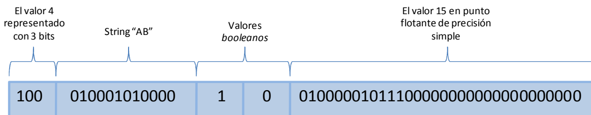
Figura 36 Varios tipos de datos empaquetados en un mensaje.
