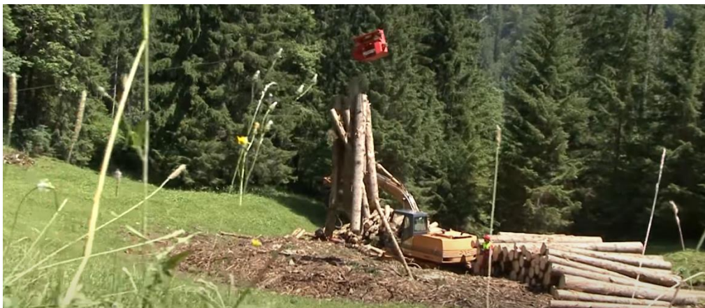
Figura 3.4 - Movimiento de trozas mediante cables propulsados [79].
