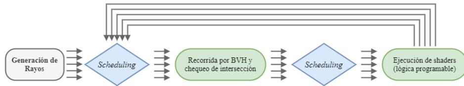
Figura 2.13: Pipeline de trazado de rayos a nivel de hardware en las tarjetas gráficas NVIDIA RTX [12].
