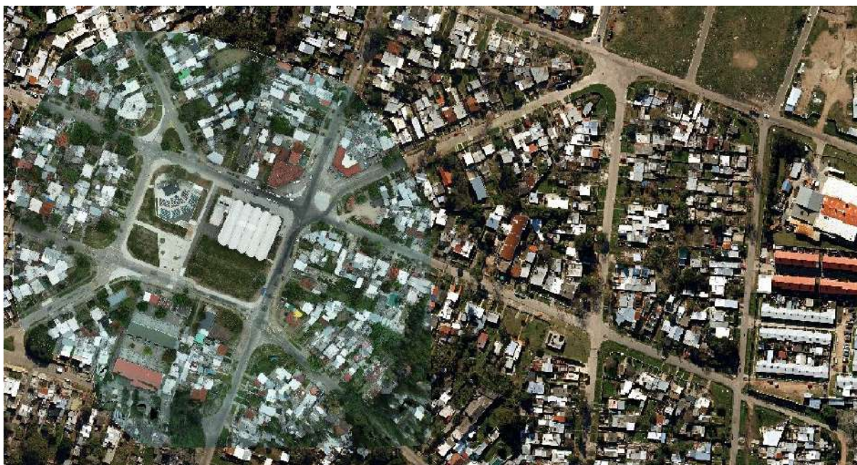
Figura 24: Ortomosaico en colores originales luego del procesamiento en Pix4D, en contraste con la imagen de IDEuy.
