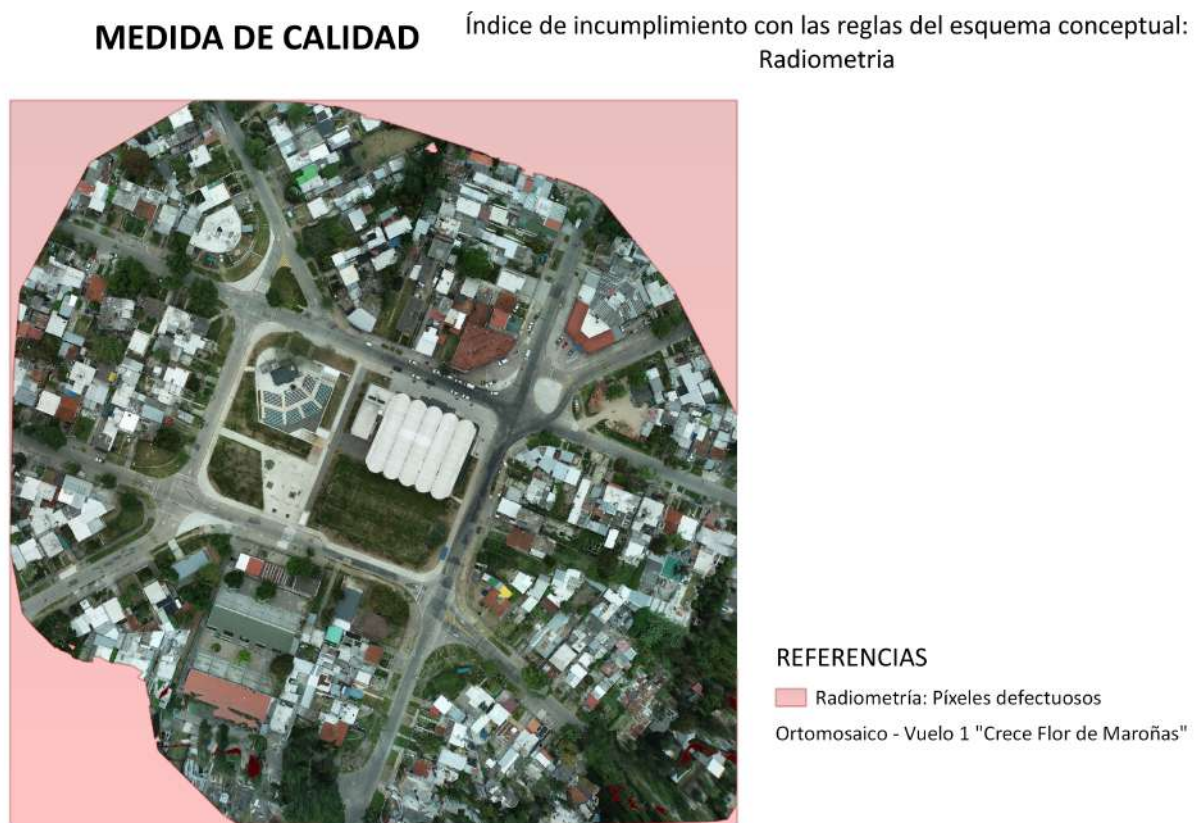
Figura 50: Resultado de la Radiometría: Píxeles Defectuosos - Vuelo 1 “Crece Flor de Maroñas”
