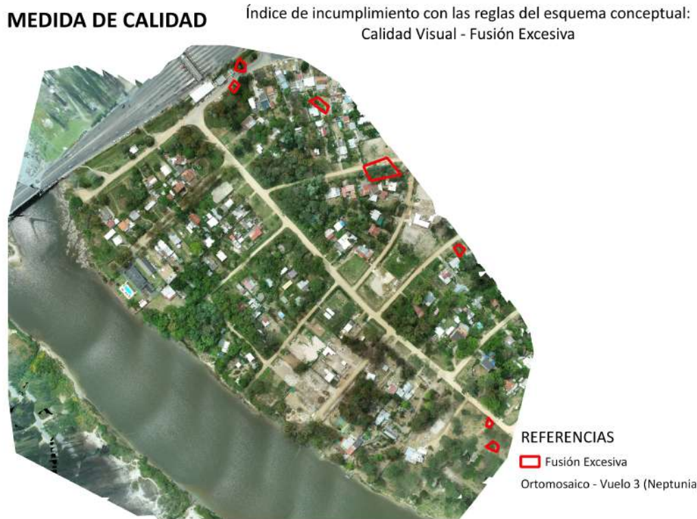
Figura 36: Resultado de la Calidad Visual: Fusión Excesiva - Vuelo 3 (Neptunia)
