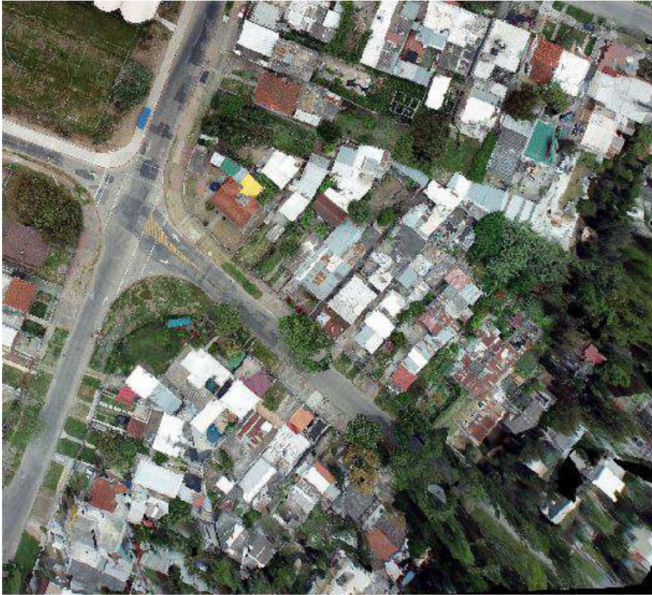
Figura 43: Ejemplo de zonas de deformaciones en los bordes del ortomosaico del vuelo Crece Flor de Maroñas.
