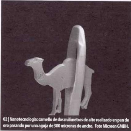
02 | Nanotecnología: camello de dos milímetros de alto realizado en pan de oro pasando por una aguja de 300 micrones de ancho. Foto Mireon GMBH.
