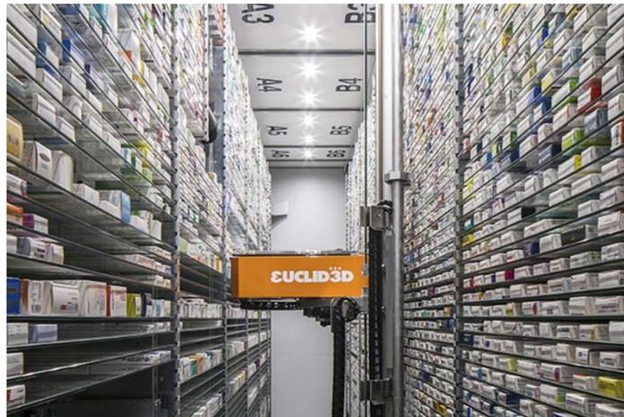
*Figura 16. Sistema de dispensación automática de orden caótico. [35]*
