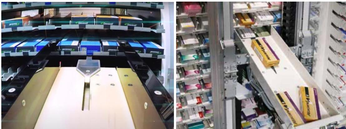
Figura 22. Manipulador de dispensación en sistema de tipo inclinado. [34, 39]
