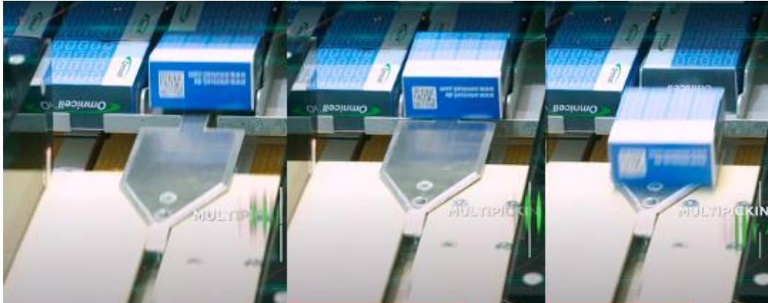
Figura 23. Secuencia de accionamiento del efector final de dispensación. [39]
