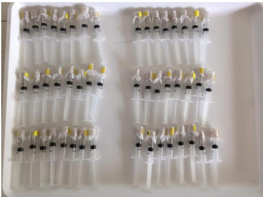
Figura 2. Jeringas, cortadas por el extremo donde se fija la aguja, con malla filtro sujeta mediante un trozo de manguera de gas.
