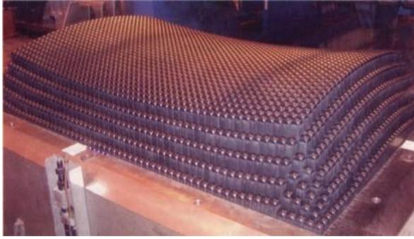
Figura 59: Resultado proyecto RTFF, herramienta reconfigurable discreta para stretch forming [Papazian 2002]
