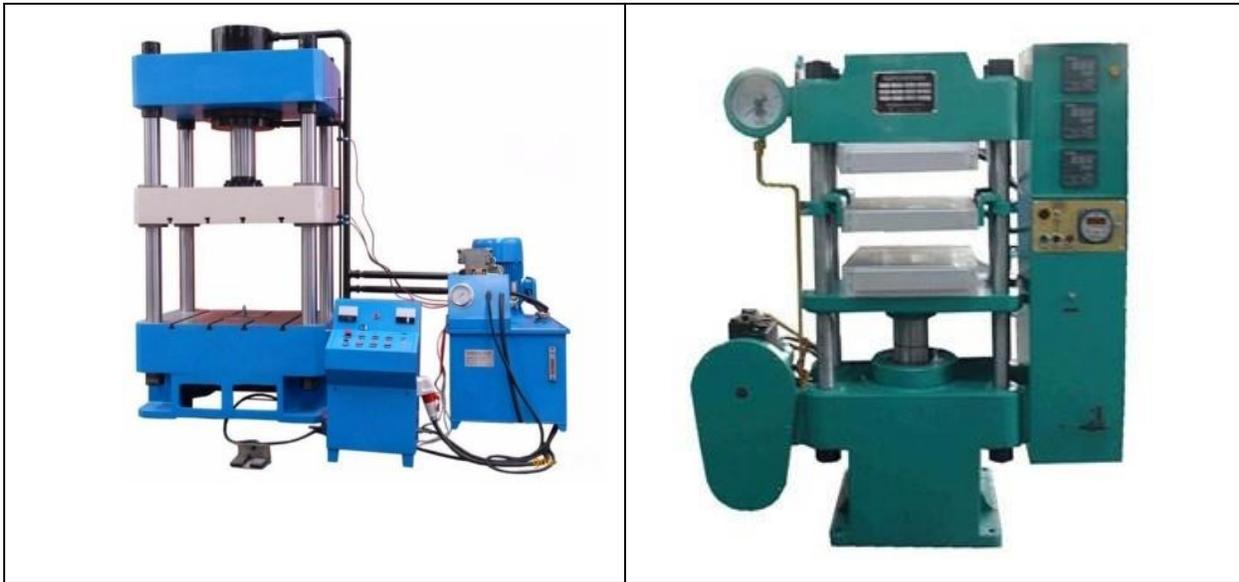
Figura 69: Prensas de estampado de 4 guías y 3 plataformas, 2 fijas y una móvil. Una de las fijas suele portar una matriz y la otra suele portar el sistema que entrega la potencia formadora. La móvil naturalmente siempre porta una matriz u otra herramienta de conformado. Ambas prensas son hidráulicas.
