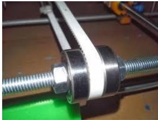
Figura 78: Sistema de correas y poleas de posicionamiento, extraído de internet.
