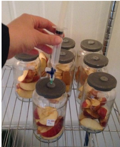
Figura No. 6. Extracción de la muestra de gas para determinar la tasa respiratoria
