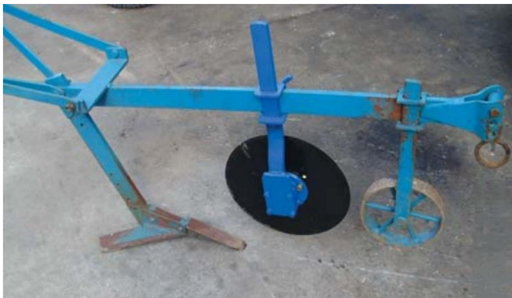
Figura 2. Multiarado, herramienta utilizada para la siembra de maíz dulce en los tratamientos con laboreo reducido
