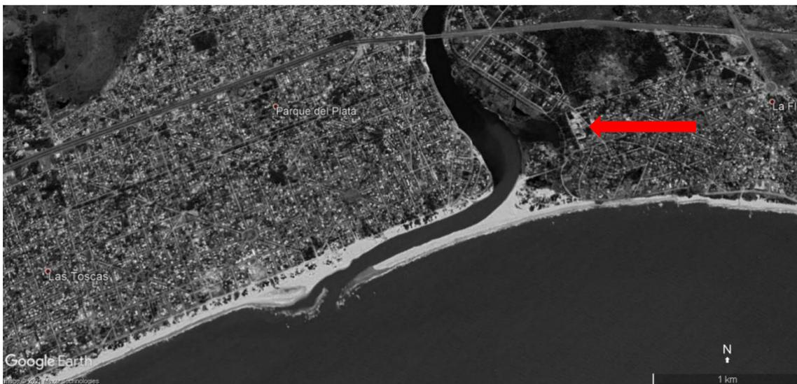
*Figura 4. Imagen satelital Google Earth de octubre de 2017 de la desembocadura del arroyo Solís Chico. Se puede observar la barra arenosa orientada al Oeste. La flecha indica un bañado que corresponde a una antigua desembocadura.*
