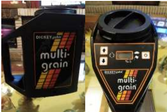
Figura 5. Medidor de humedad en grano modelo “Multi-grain Dickey John”
